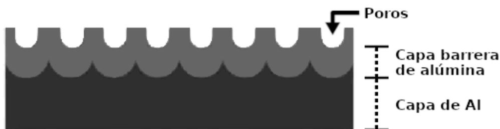
**Figura 2.4:** Esquema de un corte vertical de la membrana de OAA donde se pueden ver los poros, la capa barrera de alúmina y la capa de Al.
