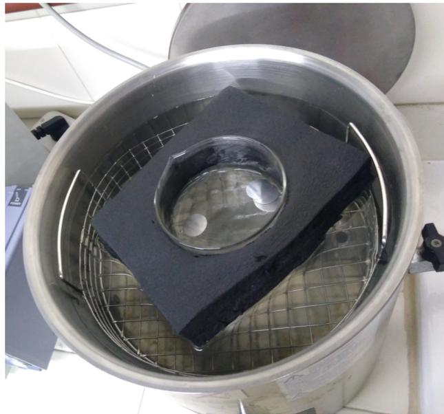
**Figura 2.1:** Foto de los discos de Al en proceso de sonicación. Los discos están en un recipiente con etanol, flotando en el agua del sonicador.
