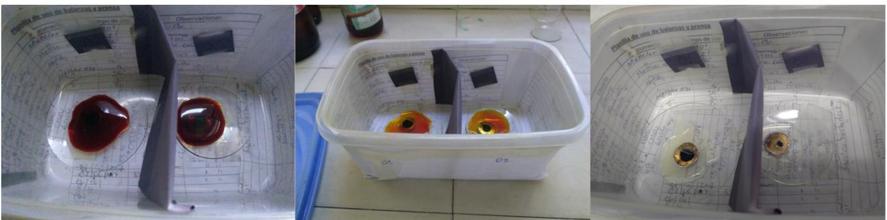
**Figura 2.8:** En esta secuencia de fotos se puede ver el proceso de remoción del Au para dos muestras. De izquierda a derecha se observa como la solución se va desgastando. El recipiente se recubrió de papel para proteger la solución de la luz. En la tercera foto aún se ve el Au.
