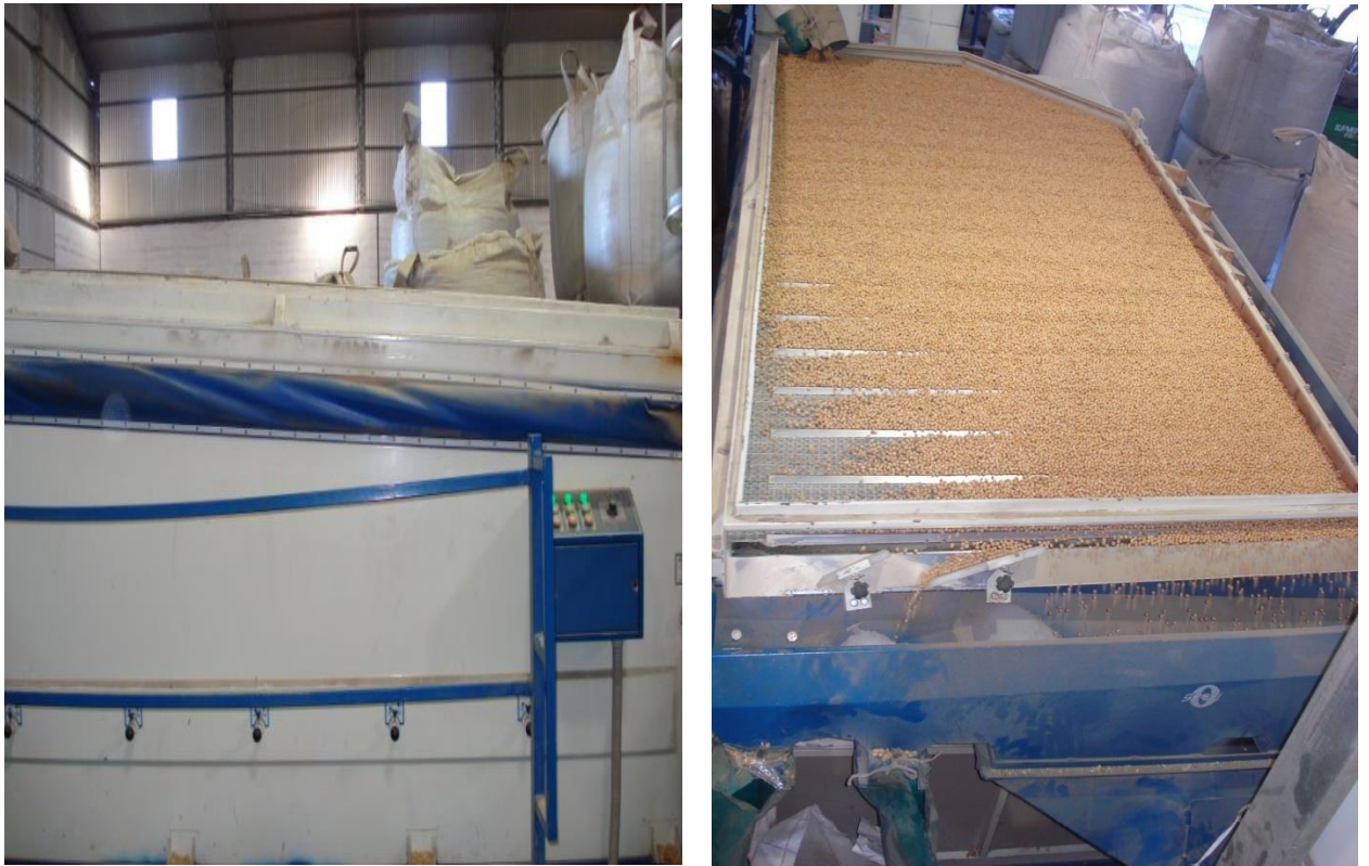
Figura 8. Densimétrica (A) vista lateral y (B) vista superior de granos de garbanzo en la planta de procesamiento de Bruno Tesan.
