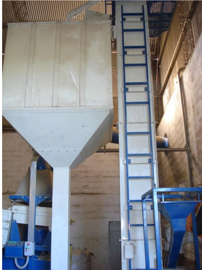
Figura 6. Tolva con llave de alimentación en la planta Bruno Tesan para el procesamiento de granos de garbanzo.
