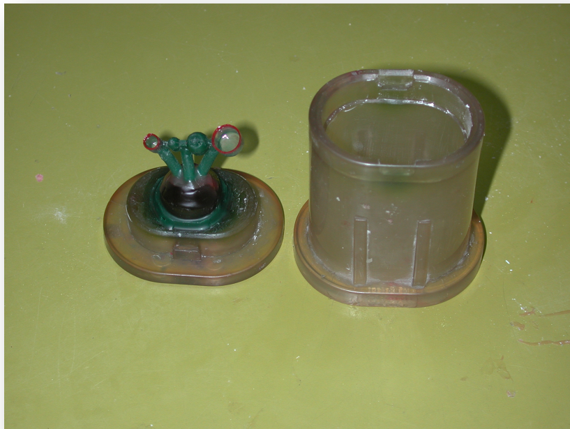
Figura 17: Probeta en sus bebederos y aro plástico oval
