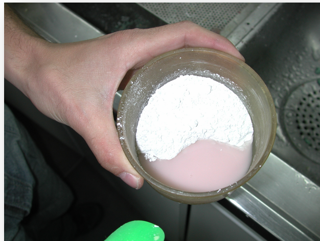
Figura 19: Mezcla de los componentes del revestimiento
