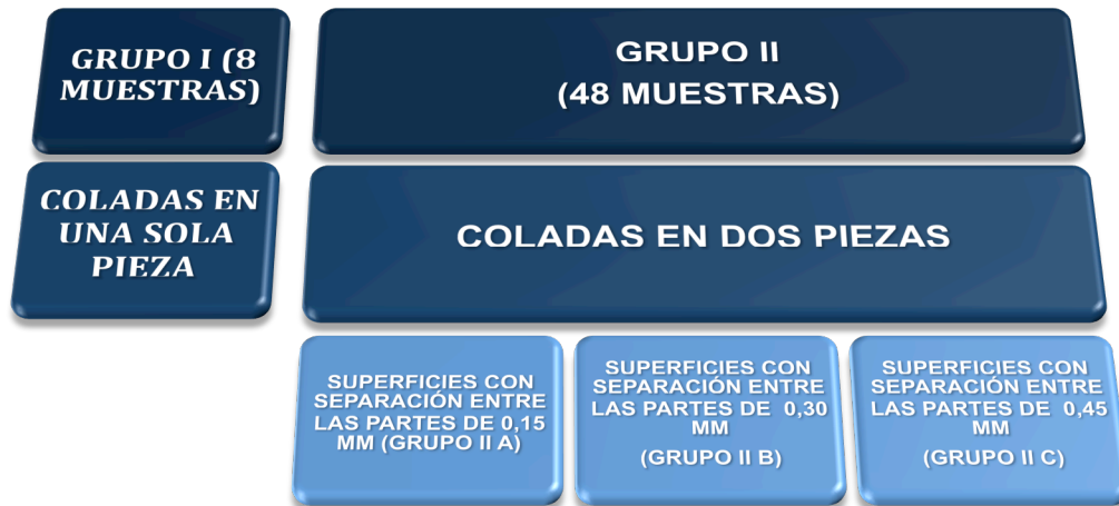
Figura 13: Esquema de la distribución de las probetas en los distintos grupos
