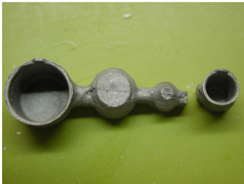
Figura 24: Colada de una probeta confeccionada en dos partes posterior a su limpieza
