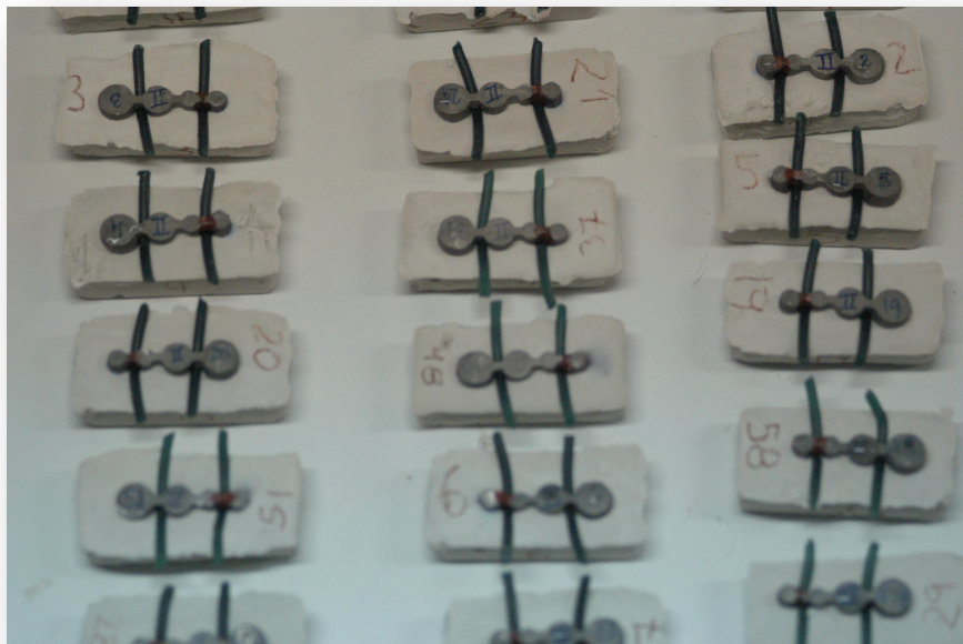
Figura 27: Estructuras a ser soldadas con soplete incluidas en revestimiento Bellatherm y con hilo de cera por debajo de las áreas a soldar para generar una vía de escape a la llama del soplete
