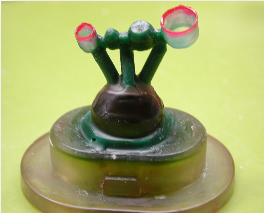
Figura 14: Colocación de los bebederos en un aro plástico oval
