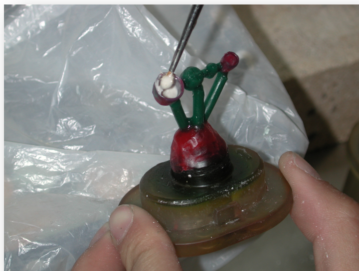
Figura 21: Llenado de las coronas con revestimiento usando un pincel
