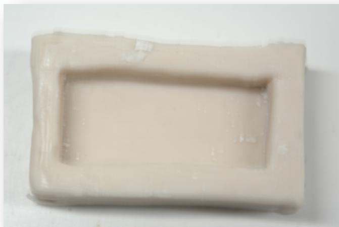
Figura 26: Molde de silicona confeccionado para obtener un tamaño uniforme de los bloques de revestimiento
