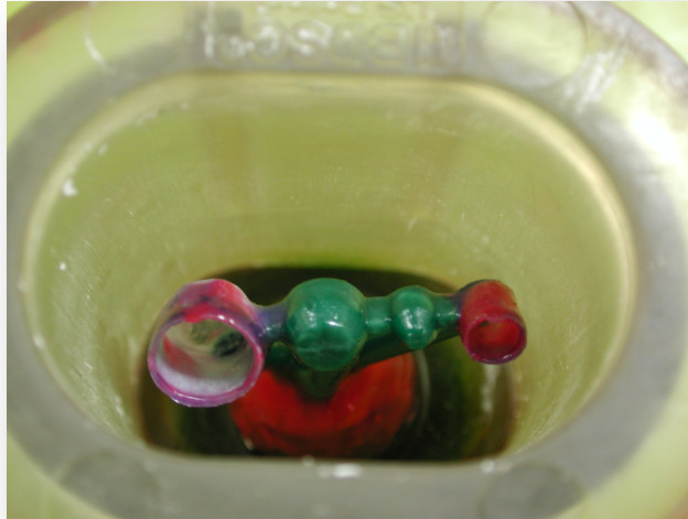
Figura 16: Se comprobó que cada patrón estuviese centrado respecto de las paredes del formador de cilindro
