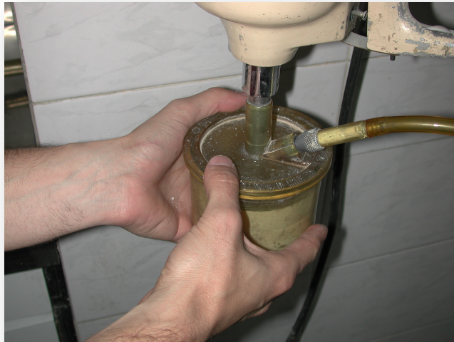
Figura 20: Esstatulado mecánico al vacío del revestimiento
