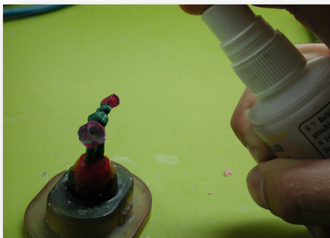
Figura 15: Aplicación de un reductor de tensión superficial
