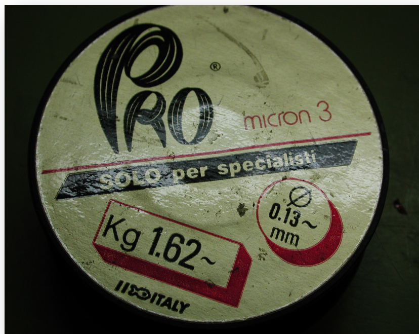
Figura 11: Tanza de 0,13 mm usada para separar las partes a soldar
