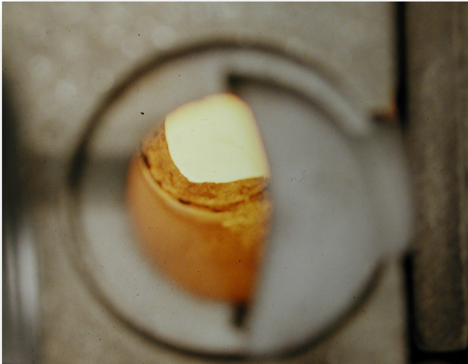
Figura 23: Colado por inducción. Calentamiento de la aleación.
