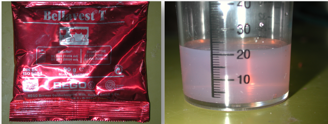
Figura 18: Revestimiento utilizado para investir los patrones
