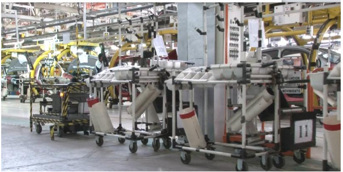
Figura 7.98: Imagen de AGV trasladando kit cars
