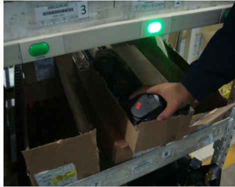
Figura 7.71: Sistema pick by light. Fuente: Elaboración propia
