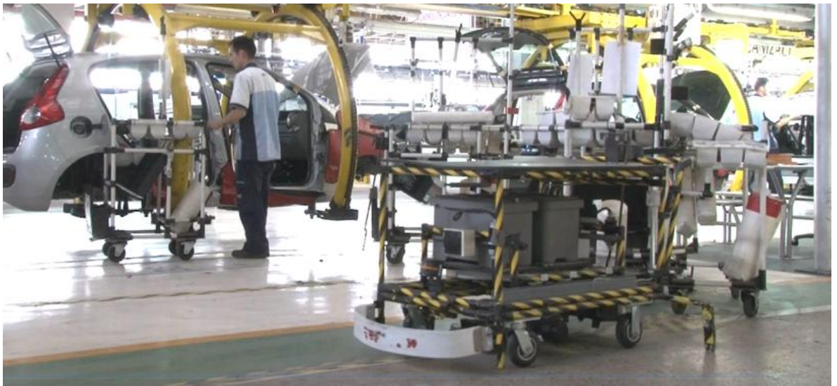
Figura 7.72: AGV utilizado para abastecimiento de kit car.
