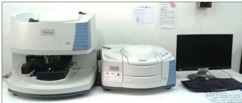
Figura 2.2 - Microscopio Infrarrojo Nicolet IN 10 con Macromódulo para ATR FCQ - UNC
