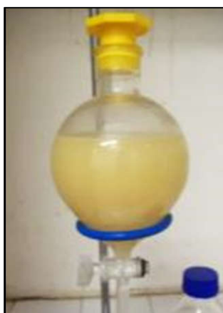
Figura 2.9 – Extracción de Aceite Hidroxilado (HSO)
