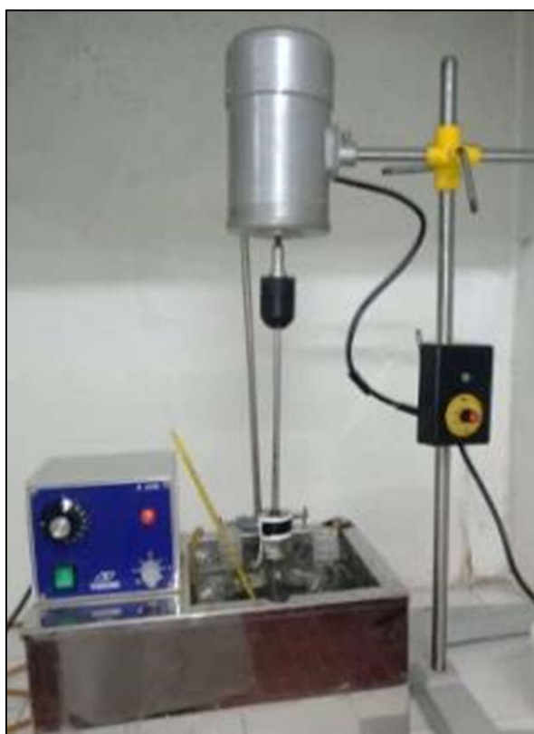
Figura 2.10 – Reactor de laboratorio para la modificación de SO 2 .
