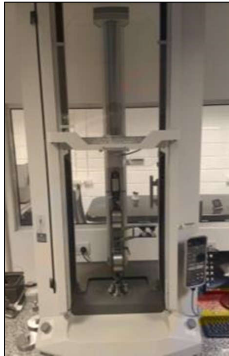
Figura 2.20 - Equipo de ensayos Universales Shimadzu AGS-X
