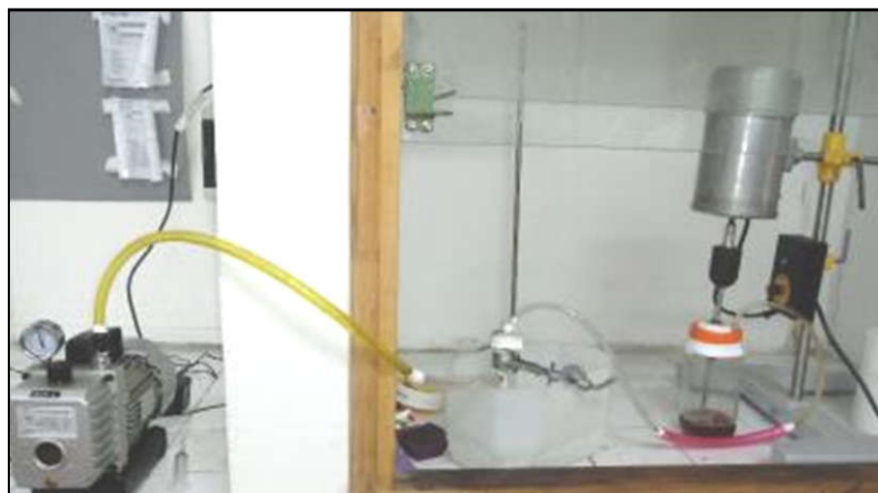
Figura 2.15 – Equipo de mezclado para copolimerización y curado
