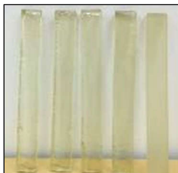
Figura 2.19 - probetas para Flexión en 3 puntos según ASTM D790
