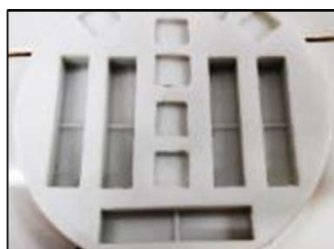
Figura 2.21 - Molde de Silicona para probetas Charpy según ISO 179
