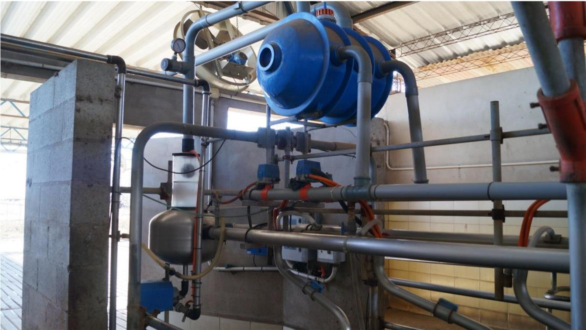
Figura 29: Descargador y vacuómetro del establecimiento.
