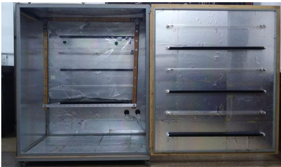
Figura 2.3: Cámara de simulación de condiciones atmosféricas: cámara de fotólisis con el reactor en su interior.
