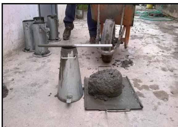
Imag. 5—15 Ensayo asentamiento hormigón fresco
