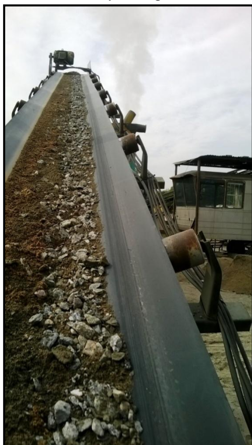
Imag. 5—6 Pastón seco en cinta transportadora
