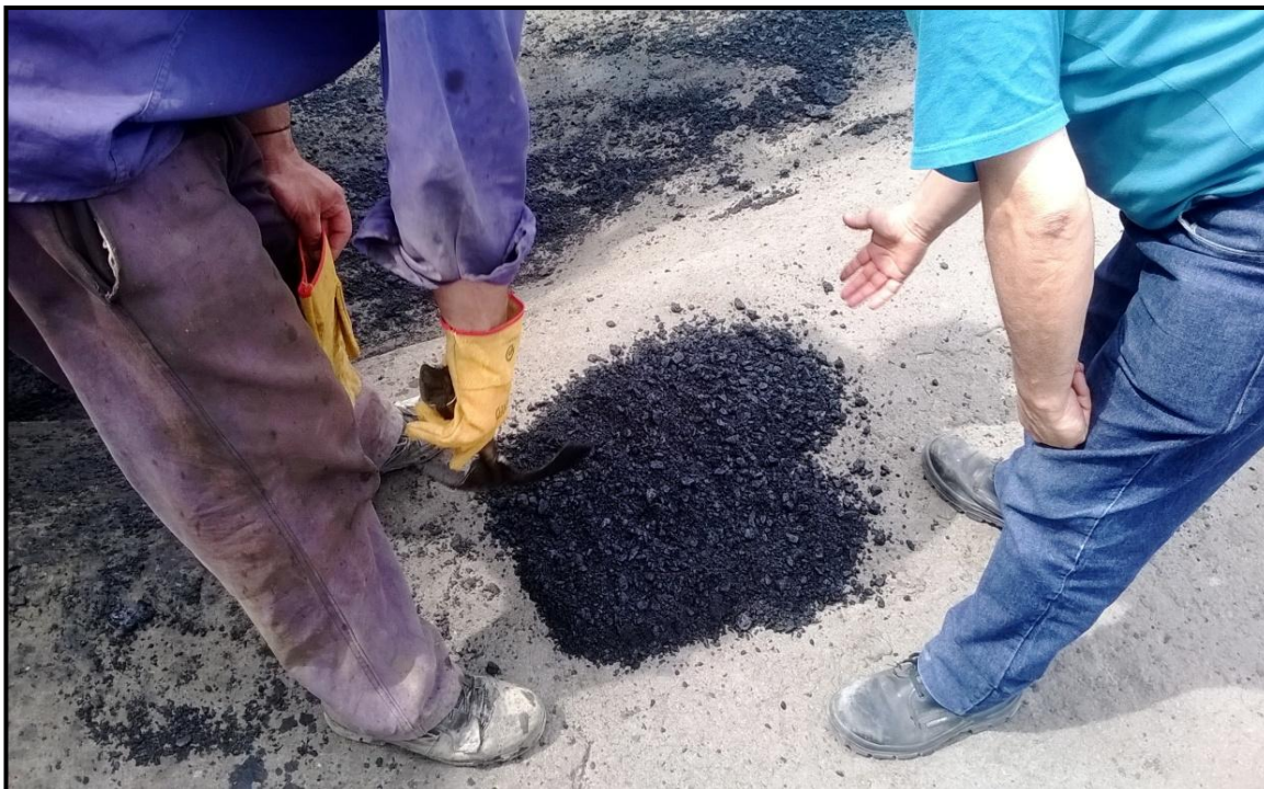
Imag. 5—10 Control de características visuales de mezcla a pie de planta
