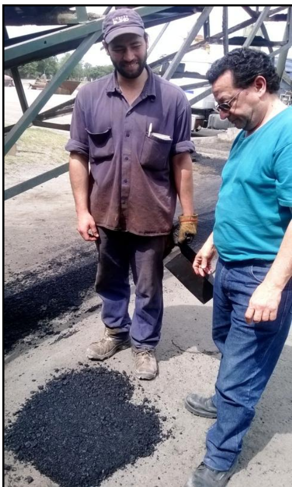
Imag. 5—9 Inspección visual de mezcla asfáltica
