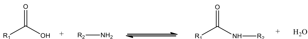
Figura 3.1. Reacción general para la obtención de amidas.
