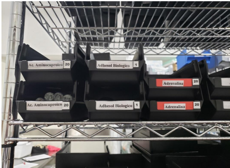
Figura 6: Sistema de doble cajetín para medicamentos según sistema Kanban
