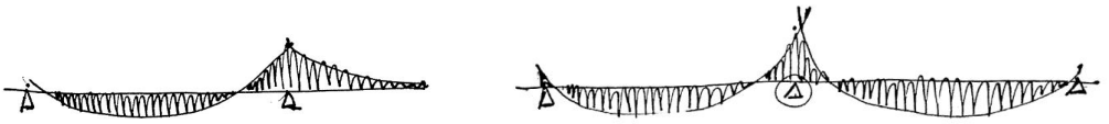
Esquema del comportamiento de las fajas de losas en la línea de las columnas
