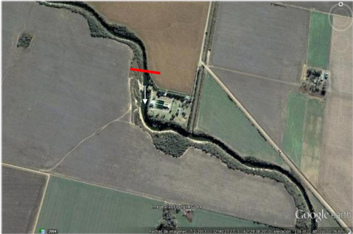
*Figura 39: Sección de aforo en el río Tercero (Ctalamochita) ubicada en el azud San Marcos.*
