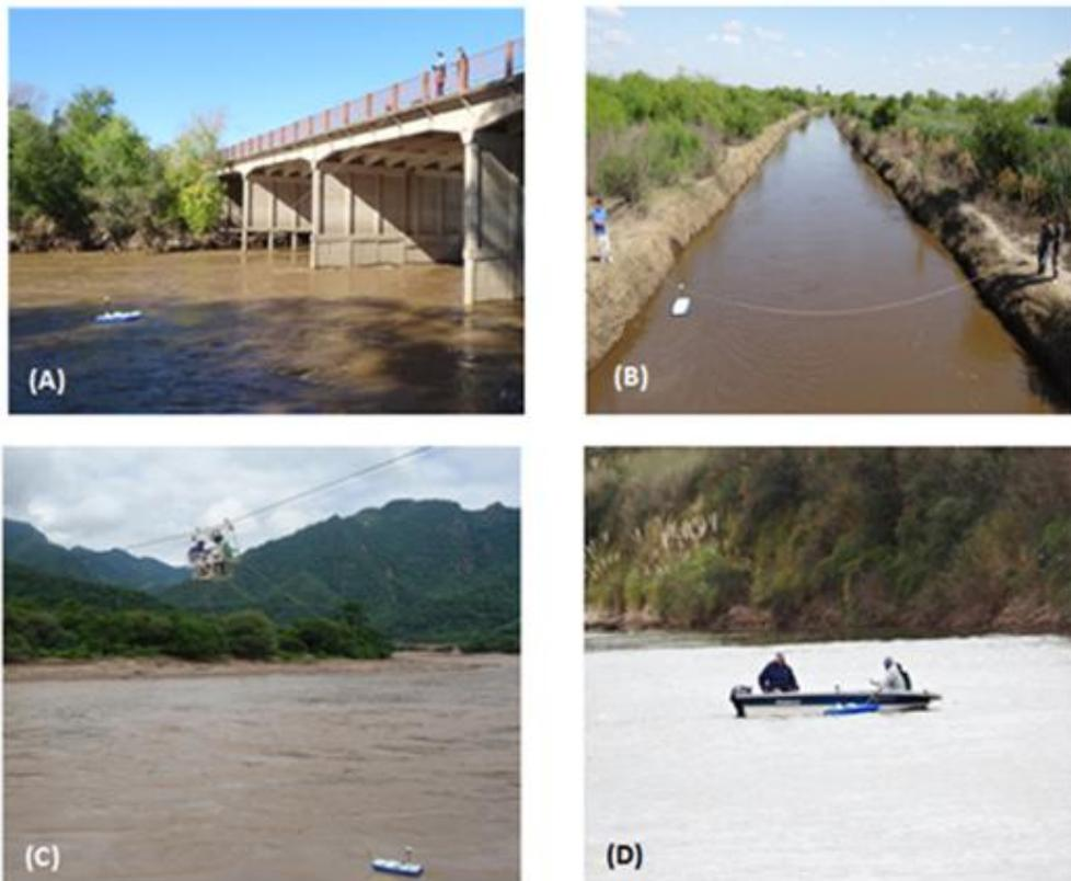
*Figura 17: Diferentes formas de operación de la plataforma móvil (A) desde puente (B) Desde las márgenes (C) Desde cable-carril (D) Desde bote. El modo de operación dependerá de las características del flujo y la sección.*
