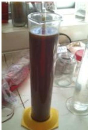
*Figura 110: Probeta con solución de suelo, agua y floculante, y el hidrómetro en su interior.*
