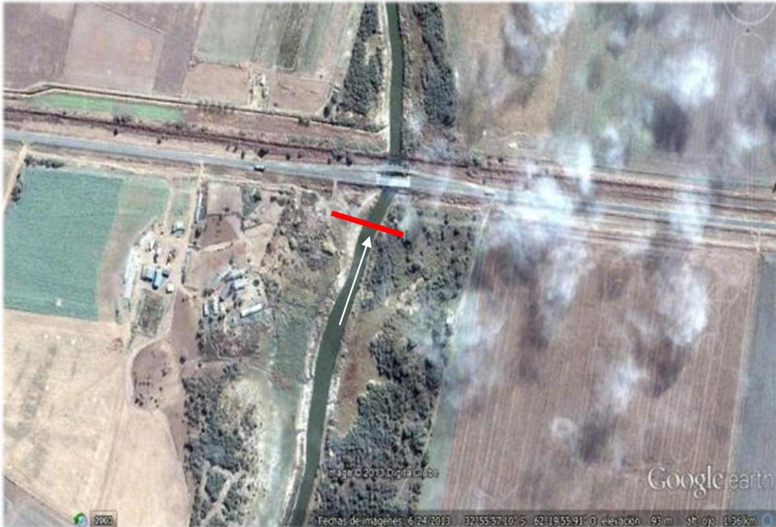
*Figura 43:* Sección de aforo en el río Saladillo ubicada en el cruce con la ruta provincial 6.
