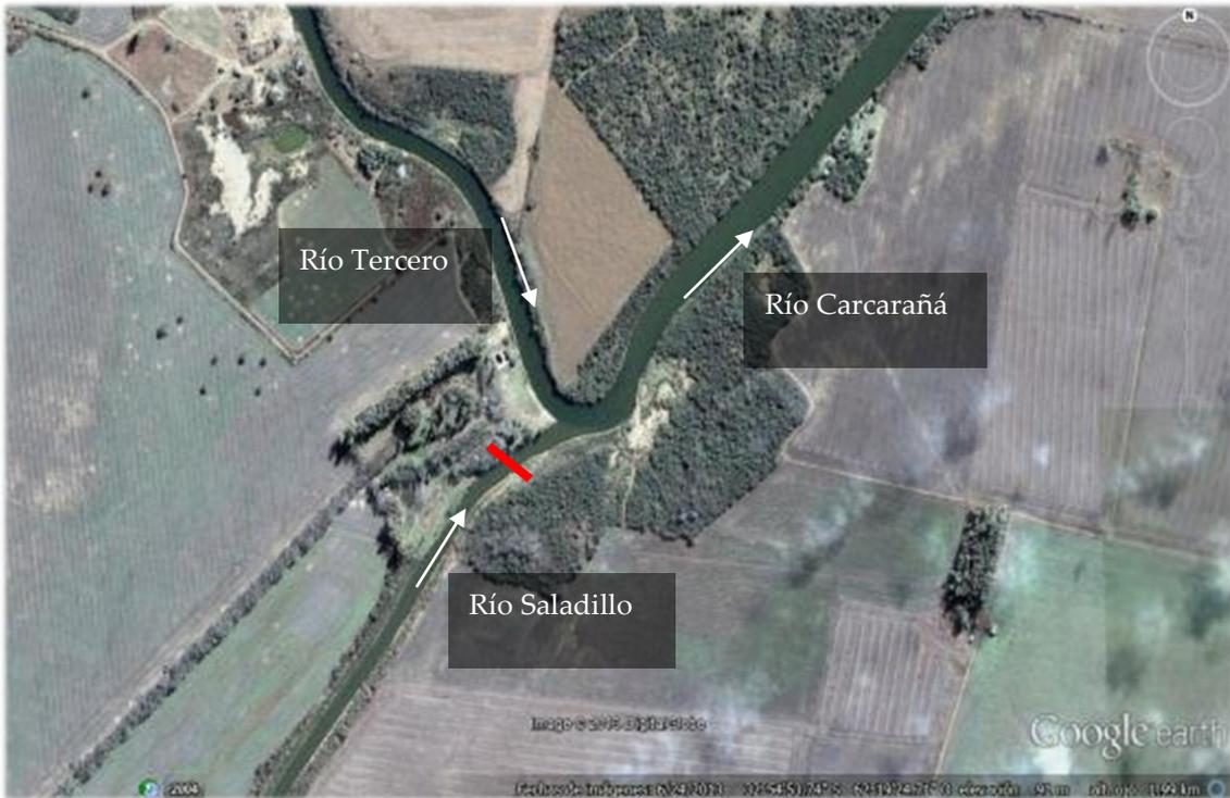
*Figura 45: Sección de aforo en el Río Saladillo ubicada en la confluencia con el río Tercero (Ctalamochita).*
