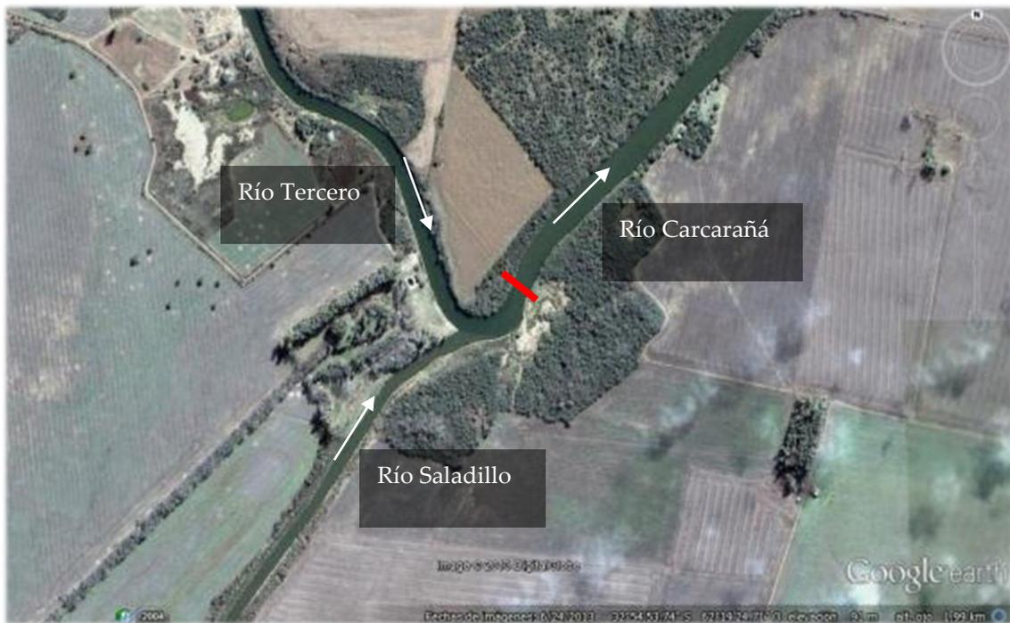
*Figura 47:* Sección de aforo en el río Carcaraña ubicada en la confluencia entre los ríos Tercero (Ctalamochita) y Saladillo.
