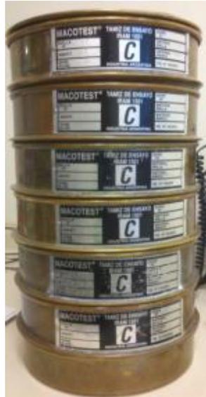
*Figura 109: Columna de tamices utilizados para realizar el ensayo granulometría en este trabajo.*
