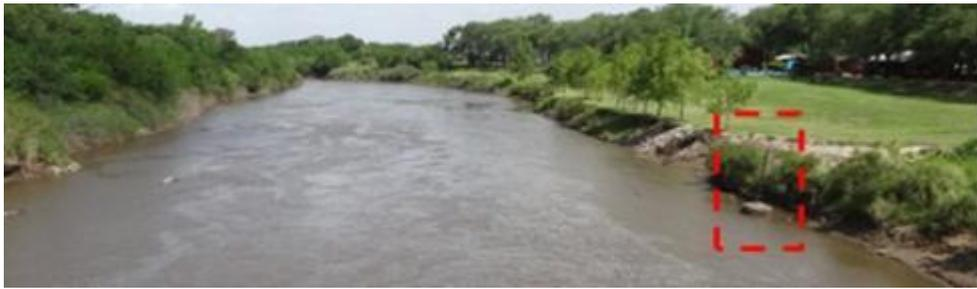
*Figura 20:* En las secciones de medición muchas veces se pueden encontrar elementos (escombros, postes, rocas, etc.) que se pueden utilizar como referencia para referenciar el instrumento y obtener una medición precisa de las márgenes.
