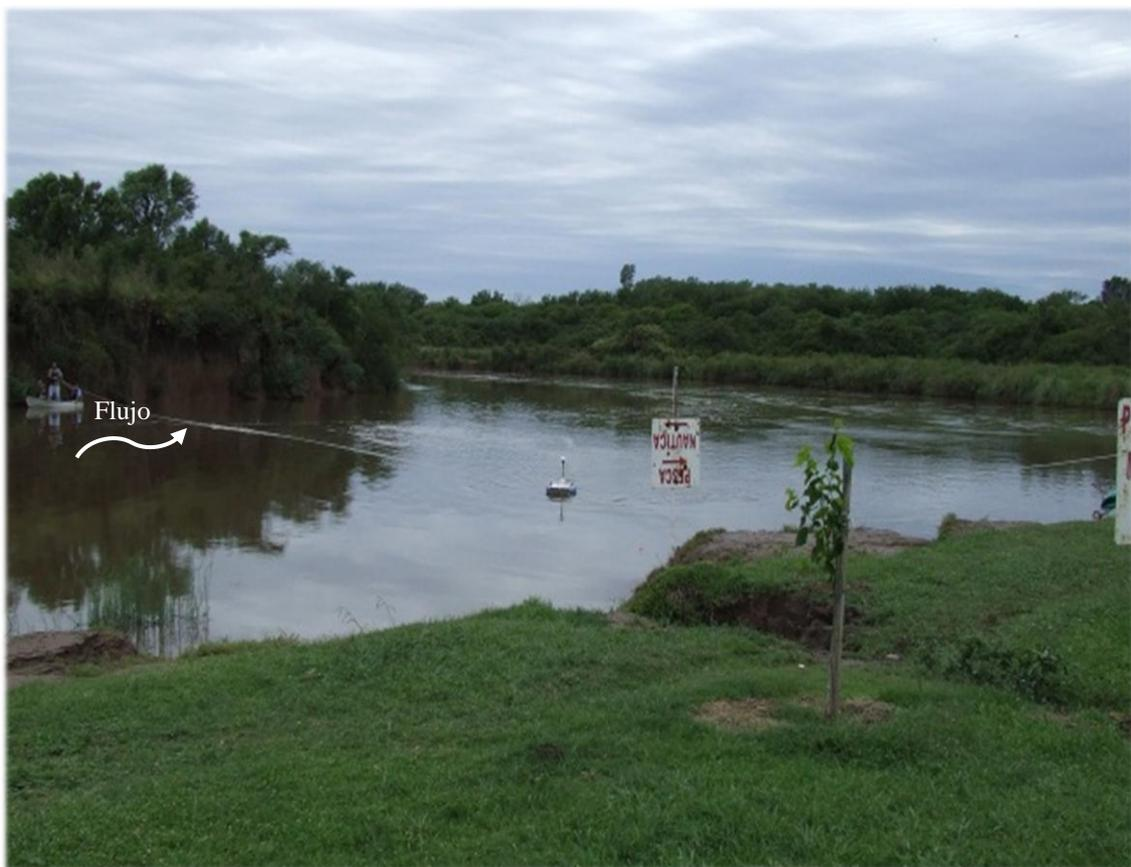
*Figura 42: Sección de aforo en el río Tercero (Ctalamochita) ubicada en la confluencia con el río Saladillo.*
