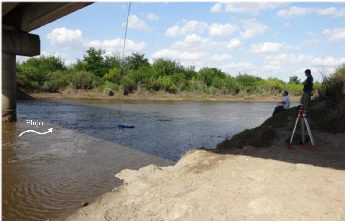
*Figura 54: Sección de aforo en el río Carcarañá ubicada en el cruce con la ruta provincial 15 (Santa Fe) en proximidades de la localidad de Cruz Alta.*
