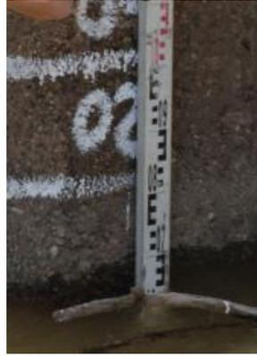
*Figura 97: Escala ubicada en el puente Alberdi de Villa Maria. Se puede observar que el “cero” de la escala se encuentra aproximadamente a 60 cm del lecho en esa pila, lo cual indica que existen situaciones en donde el flujo escurre con niveles de superficie libre por debajo del cero de la escala.*
