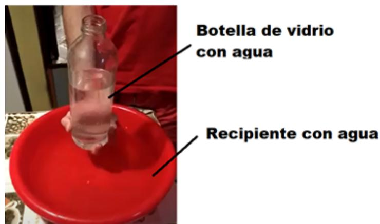
Figura 10: Elementos utilizados en el experimento de presión atmosférica.
