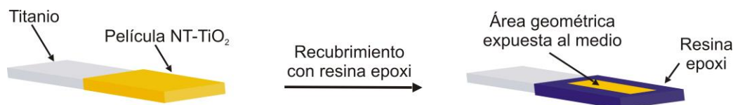
Figura 2.3. Esquema representativo del aislamiento de la película NT-TiO 2 mediante el recubrimiento con resina epoxi.
