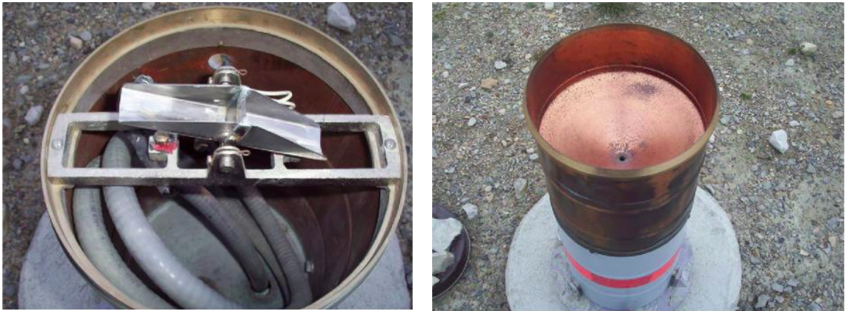
Figura 3.1: Interior (imagen izquierda) y exterior (imagen derecha) de un pluviómetro cangilonado. Imágenes extraídas de [4].
