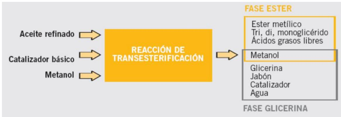
Imagen 5.3: Esquematación del proceso de transesterificación
