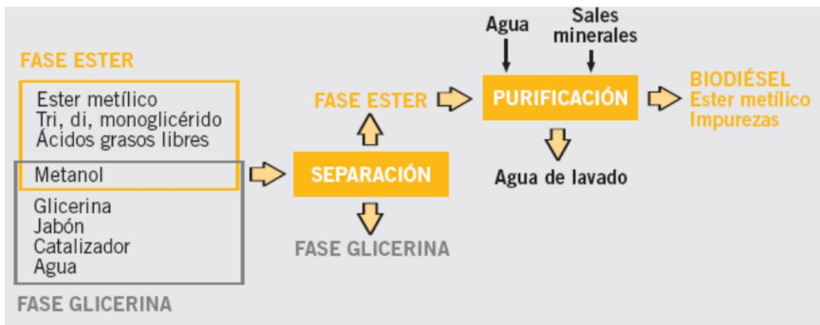
Imagen 5.4: Esquematación de los procesos posteriores a la transesterificación
