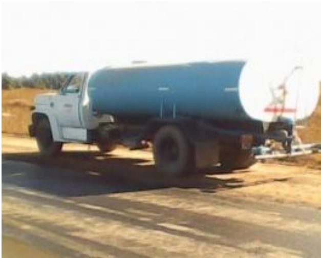
Figura 23: Imagen Camion Regador, tanque 10000lts.
