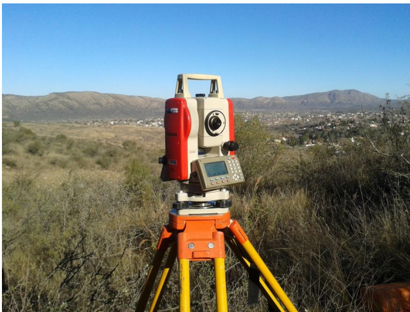
Figura 16:Fotografía Estación total situado en punto estratégico del loteo
