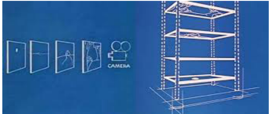
► Imagen digitalizada de Mesa multiplano. Posición de los niveles con respecto a la cámara.
