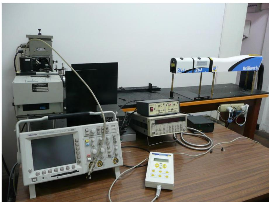
**Figura 2.3** Sistema láser para las mediciones resueltas en el tiempo
