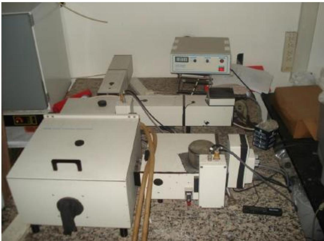
**Figura 2.4** Espectrofluorómetro PTI de Quanta Master 2
