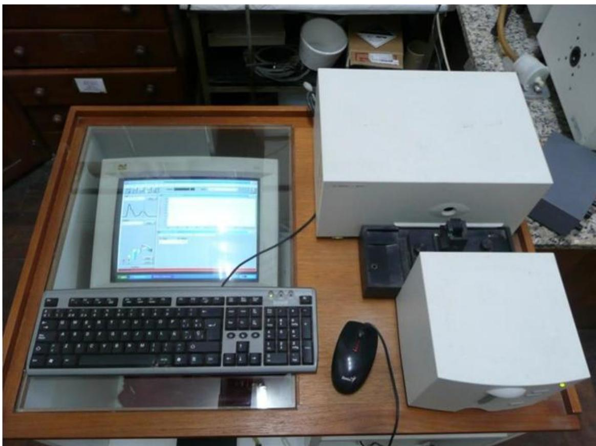
**Figura 2.2** Espectrofotómetro de Absorción UV-visible
