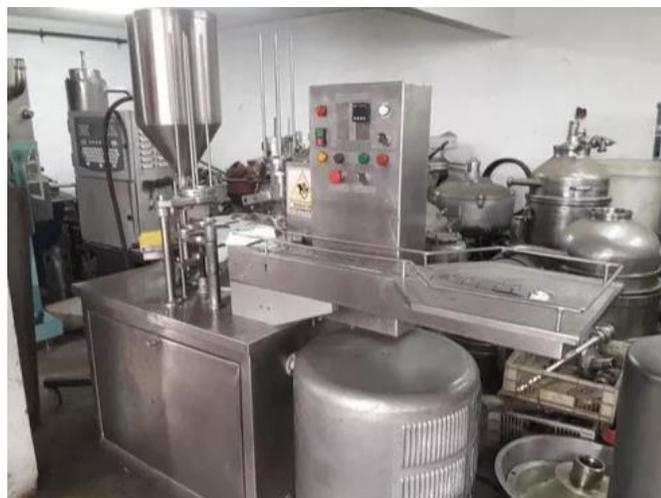
**Figura 11:** Envasadora de crema automática de la marca Primo.
