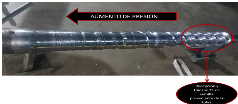
Figura 22: Detalle tornillo sinfín para la extracción del aceite en la empresa Barbieri.
