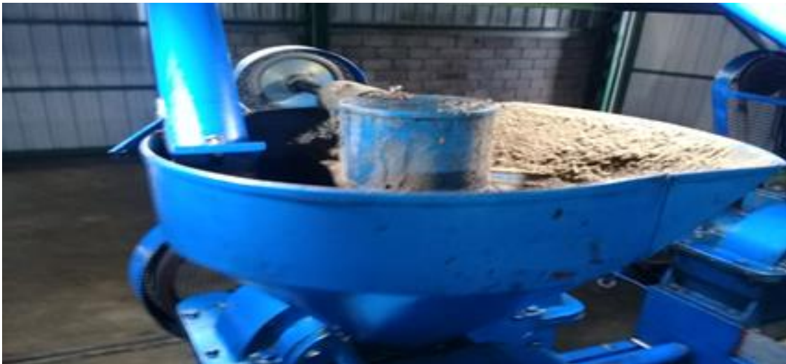
Figura 20: Tolva alimentadora de prensa de granos en la empresa Barbieri.
