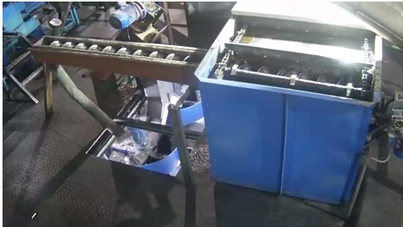
Figura 24: Borrero para la separación de impurezas en la empresa Barbieri
