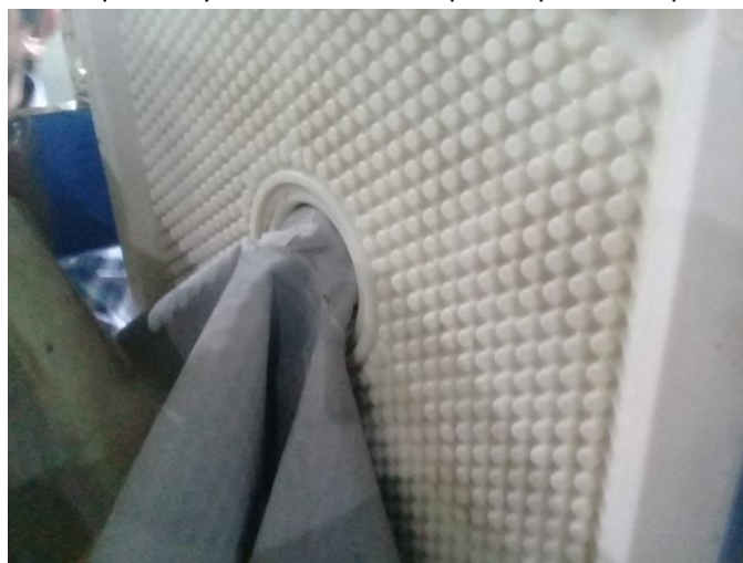
Figura 29: Placa con paño filtrante en el sistema de filtrado de aceite en la empresa Barbieri
