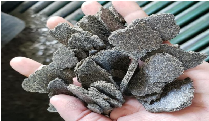
Figura 27: Expeller, subproducto del prensado obtenido en la empresa Barbieri.
