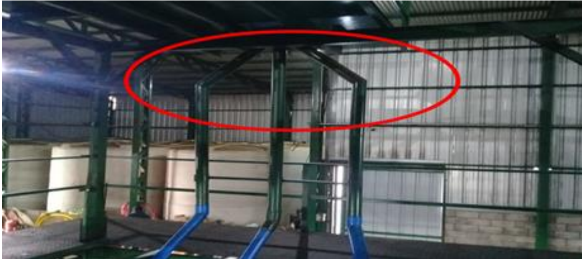
Figura 19: Conductos distribuidores de granos en la empresa Barbieri.
