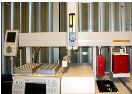
Figura 1. Automuestreador Varian Combi PAL para SPME
