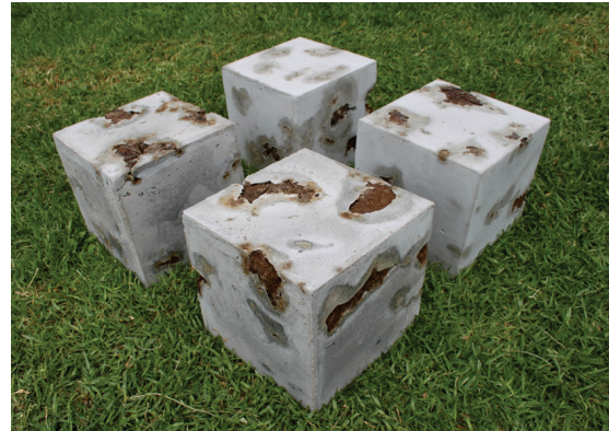
Fig. 21. Cubos de concreto y estiércol.
