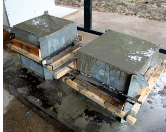
Fig. 20. Moldes metálicos con tutores externos.
