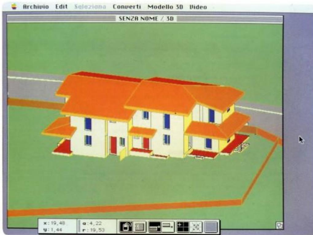
Figura 3-6: Esta captura de pantalla de Radar CH (más tarde ArchiCAD) muestra hasta qué punto las capacidades de modelado BIM se habían desarrollado para 1984, el primer lanzamiento importante BIM en un ordenador personal.
