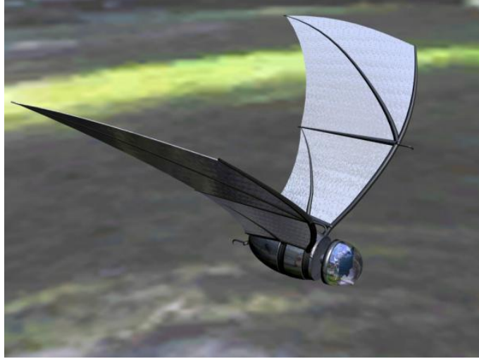
Figura 2.1: Microvehículo aéreo capaz de ejercer tanto el vuelo estacionario como el inestacionario.
