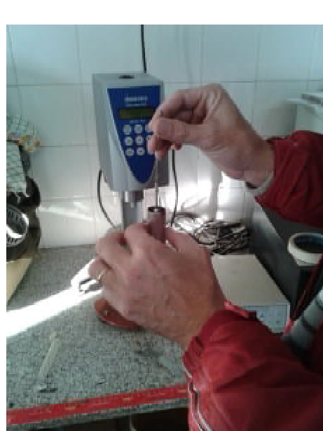
Figura 110 VISCOSIDAD DEL CEMENTO ASFALTICO
