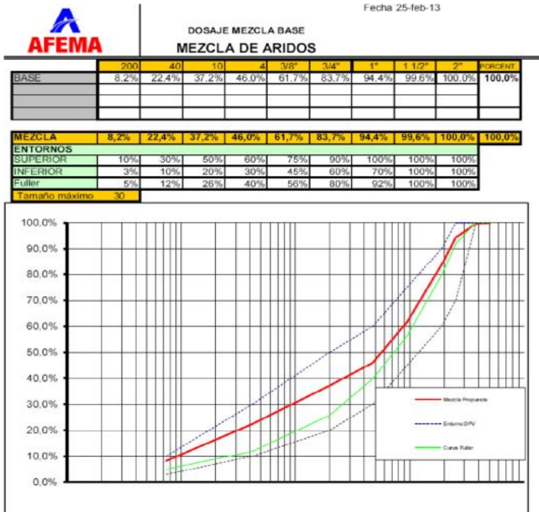
Figura 64 Dosificación Base Granular [CBR]
