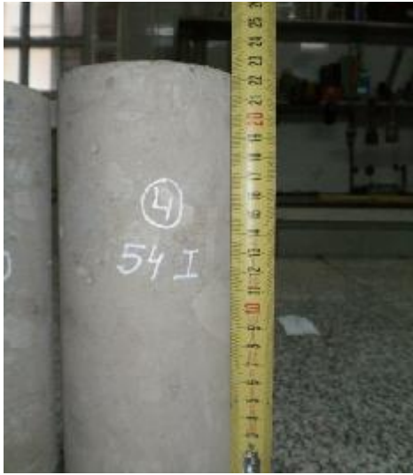
Figura 112 TESTIGO DE HORMIGON
