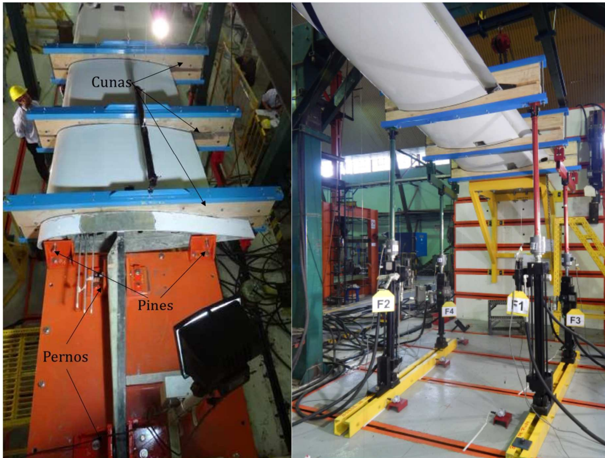
Figura 200 – Estructura Montaje – Ensayo Estructural Estático Semi-Ala AEE
