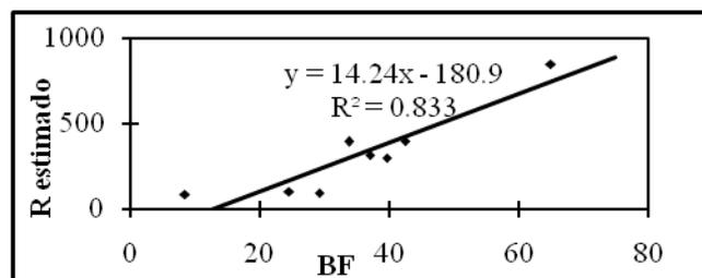
Figura 1. Correlación entre los valores calculados de  $R$  y los valores estimados por el Burst factor.
