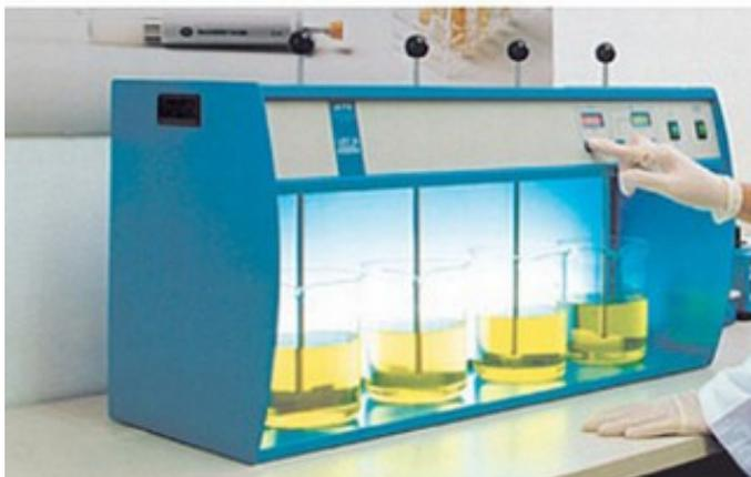
Consiste en un equipo con cuatro puestos programables donde se colocan las jarras. Tiene una varilla agitadora en cada puesto y pueden regularse el tiempo (en minutos) y la velocidad (en rpm) de agitación.
