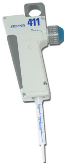
Las pipetas automáticas son dispositivos que se caracterizan por carecer de depósito y se utilizan principalmente para medir o transvasar pequeños volúmenes de líquido de un recipiente a otro con gran exactitud.
