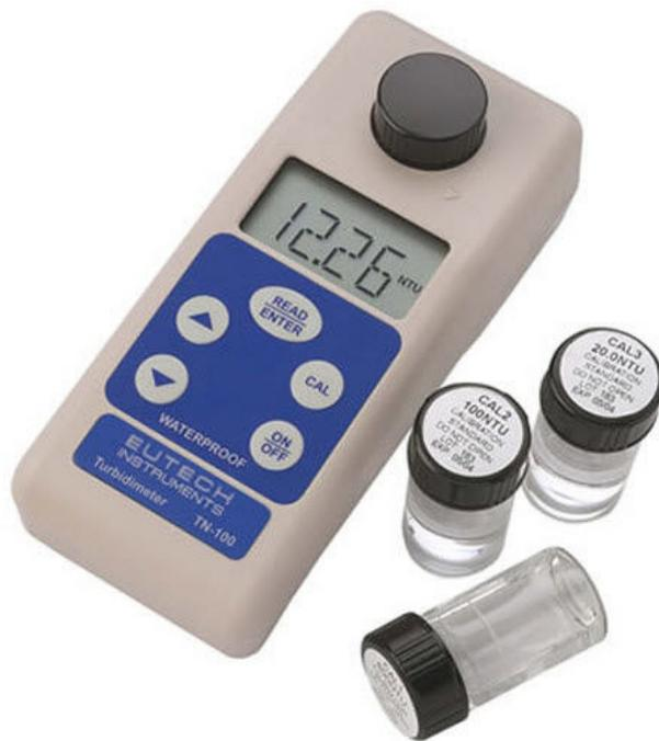
El turbidímetro mide por infrarrojos un rango de 0 a 1000 NTU (Unidades Nefelométricas de Turbidez) y dos escalas de medición, de 0 a 50 y de 50 a 1000. El equipo selecciona automáticamente el rango apropiado, de acuerdo con la turbidez de la muestra. Se ha diseñado de acuerdo con el Standard internacional ISO 7027. El microprocesador reconoce automáticamente los valores fijos de 0 y 10 NTU para
