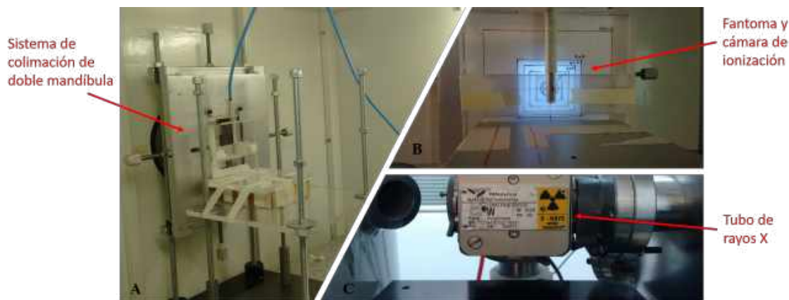
Figura 2.3: Instalaciones de LIIFAMIR ® : A) Configuración de lectura de tasa de dosis. B) Cámara de ionización en fantoma de PMMA con colimación del campo de radiación. C) Fuente de rayos X.
