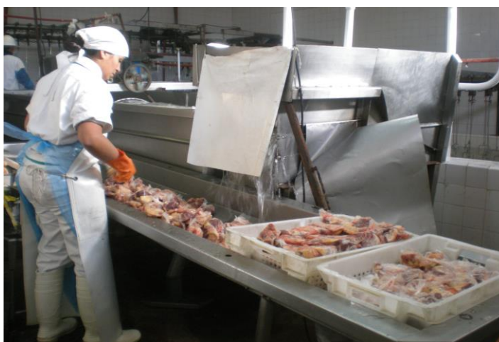
Figura 19: Batea de chiller, operaria receptando los pollos
