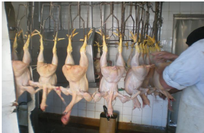
Figura 16: Operario cortando cabeza y una pata (frente). Sierra automática encargada de cortar la otra pata (fondo)
