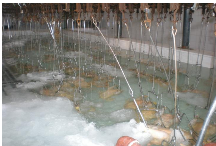
Figura 18: Pollos circulando en la pileta pre-chiller
