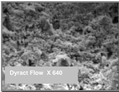
Figura 22. Macrofotografía con M.E.B del compómero flow luego de ser ensayada.
