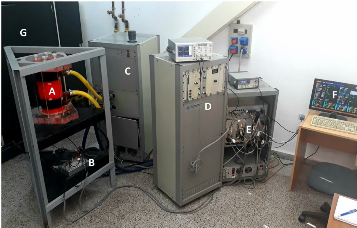
Figura 3.1: Fotografía del prototipo. A) Electroimán tipo Notch en su cámara de montaje y refrigeración, inmerso en el fluido refrigerante color naranja; B) pre-amplificador de RF; C) sistema de refrigeración; D) fuente de corriente y unidad de control; E) consola junto al transmisor Stelar; F) PC de comando de la consola Stelar; y G) rack con los amplificadores de gradiente. La consola SpinCore se encuentra a la derecha de la fotografía, aunque no llega a observarse, incorporada a una segunda PC desde donde se controla a todo el sistema.
