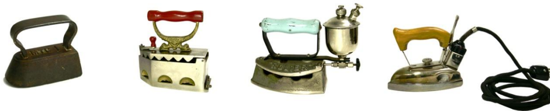
Planchas en secuencia evolutiva desde el uso del carbón hasta la electricidad. Museo Ingenium del Centro de Cultura Tecnológica – Córdoba – Argentina – Fot. Cortesía del Museo.
