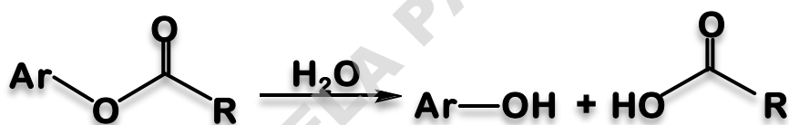
Esquema 4.1. Reacción general de hidrólisis de un éster.
