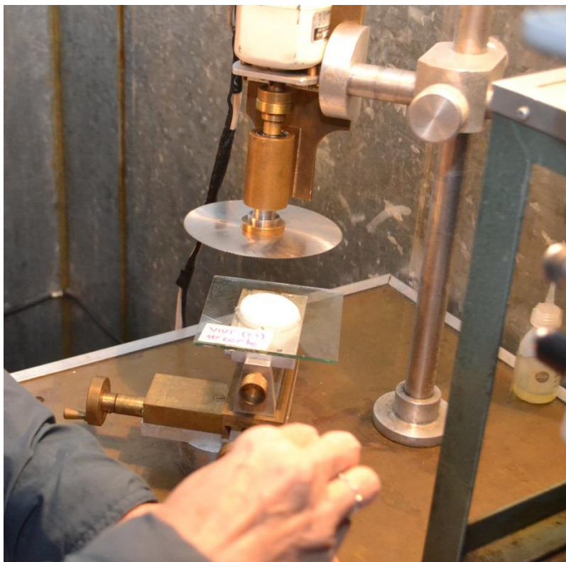
Figura 13. Equispo de cre en la cámara fría para un granizo pequeño y corte final manual del coloso
