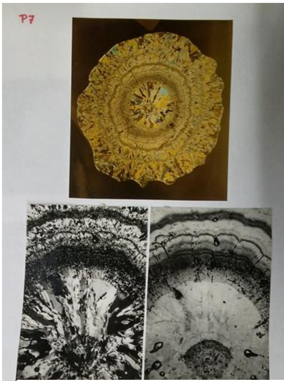
Figura 9. Fotografías obtenidas con microscopio por luz blanca del Granizo P7 de Alta Gracia 1988. Las microfotografías superior y su ampliación abajo a la izquierda están tomadas entre polarizadores cruzados por lo que pueden observarse los cristales.
