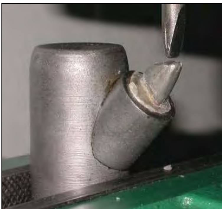
Fig.57: Aplicación de las cargas compresivas no destructivas.
