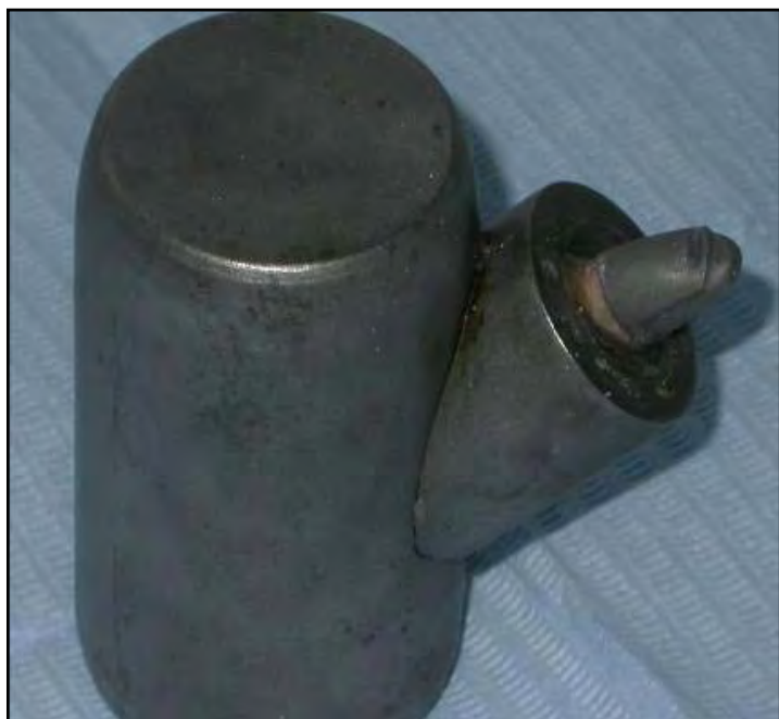
Fig.51: Soporte metálico con el taco de acrílico montado.
