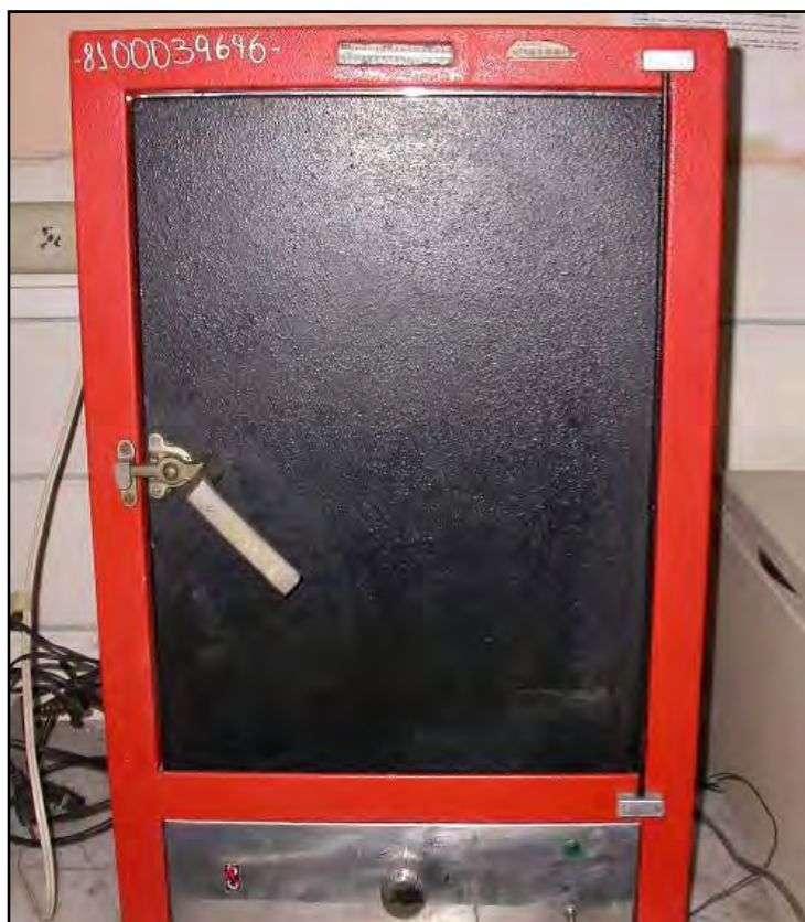
Fig.60: Estufa para mantener la temperatura constante 37° por 72 horas, simulando las condiciones de la cavidad bucal.
