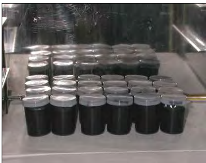
Fig.61: Muestras en azul de metileno, en la estufa a temperatura constante.
