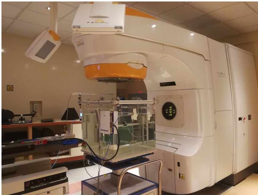
Figura 3.1: Acelerador lineal Novalis TX (Varian-Brainlab) y fantoma iba Blue Phantom.
