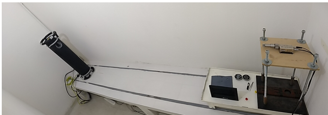
Figura 3.6: Montaje experimental, distancia fuente-detector: 220 cm.
