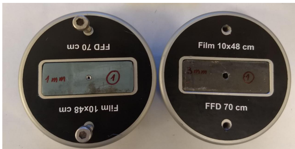
Figura 3.2: Colimadores de 1 mm y 3 mm de diámetro adaptados a los colimadores provistos por el fabricante.
