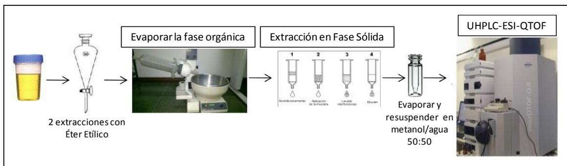
Figura 16: Procedimiento de extracción 2
