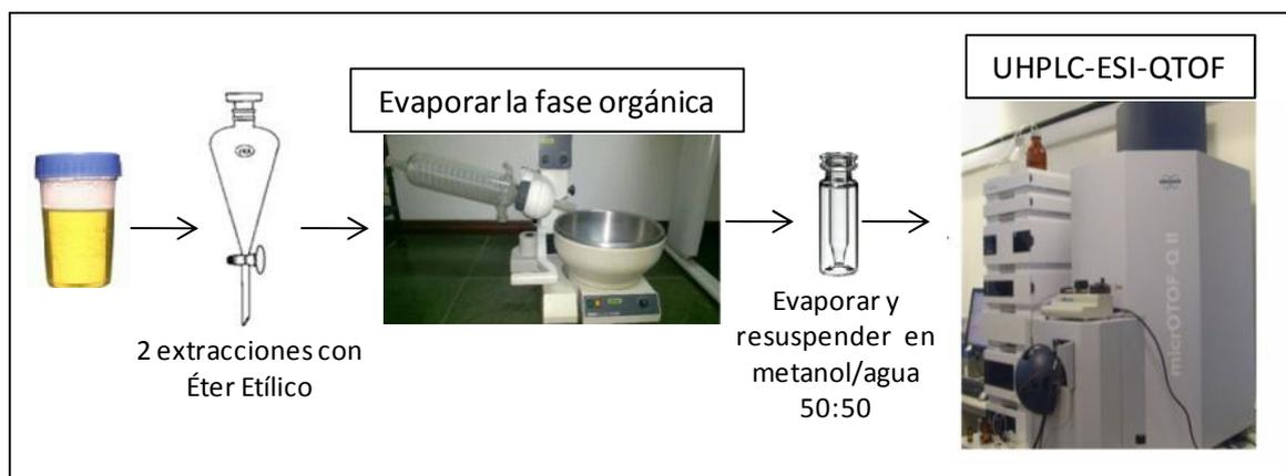
Figura 18: Procedimiento de extracción 3
