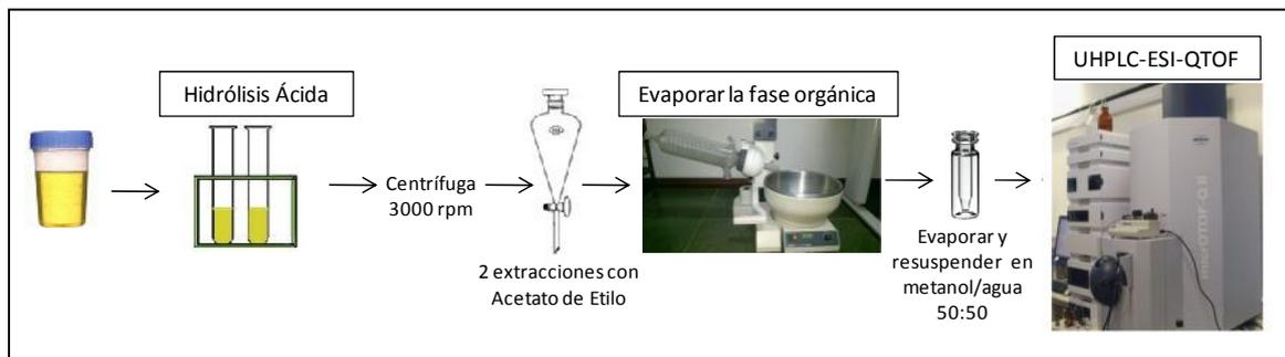
Figura 20: Procedimiento de extracción 4
