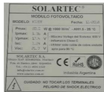
Figura 7: Ubicación del panel fotovoltaico y del gabinete IP65 (der.). Fotografía del panel fotovoltaico: Modelo 20 Wp 12V.
