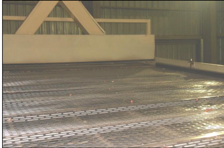
Figura 13: Zarandas planas utilizadas para clasificar por tamaño el grano de maní en la planta de procesamiento del semillero El Carmen, General Cabrera, Córdoba.
