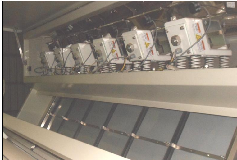
Figura 12: Máquina fotoelectrónica dicromática en la planta de procesamiento de semillero El Carmen, General Cabrera, Córdoba.
