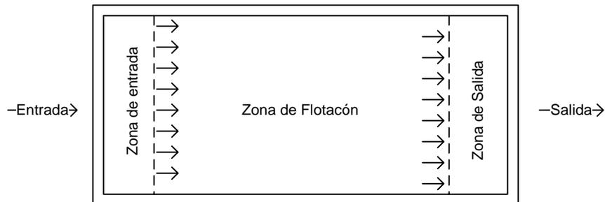
**Figura 26:** Esquema en planta de la cámara interceptora de grasas
