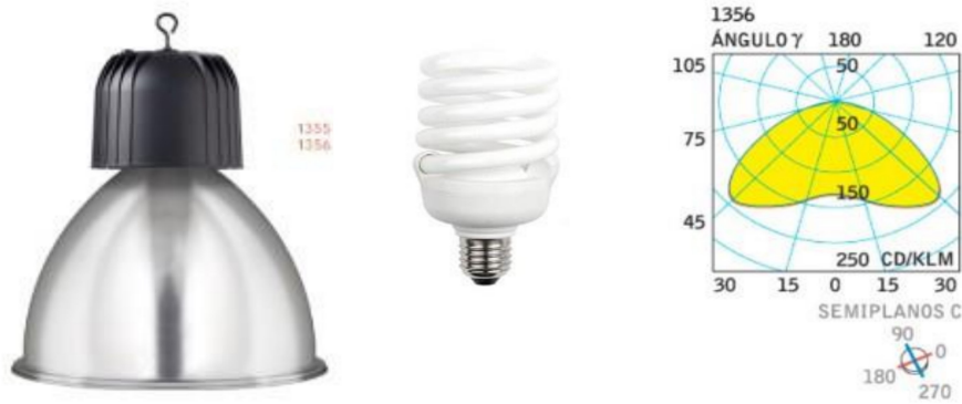
Figura 9. Sistema de iluminación existente en Aula Norte 2: Artefacto tipo campana naval de aluminio mate. Lámpara de bajo consumo de 50 w de potencia color frio. Curva fotométrica de la luminaria.
