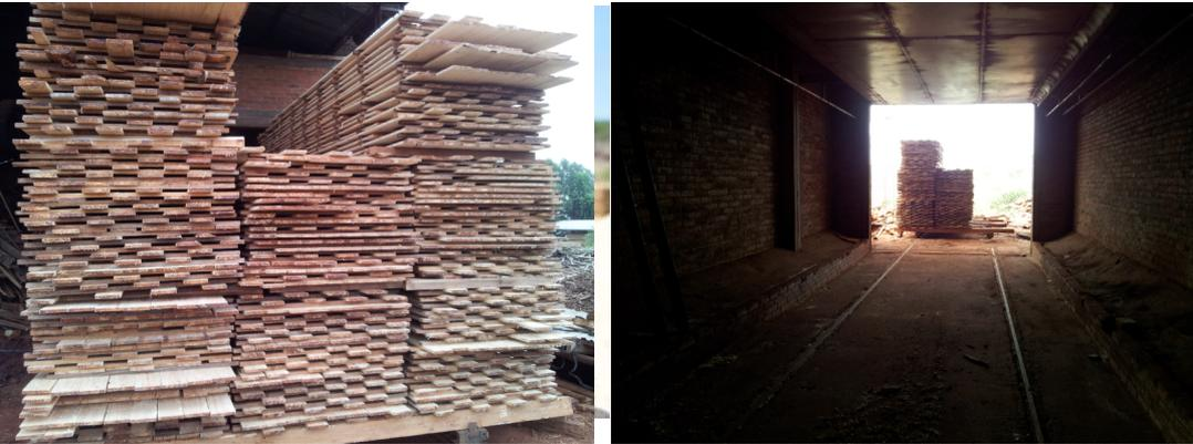
Una vez que pasaron las horas que normalmente necesita el proceso de secado, se abre el horno y se mide la humedad de algunas tablas elegidas al azar para corroborar si el material está listo o no para ser sacado del horno.
