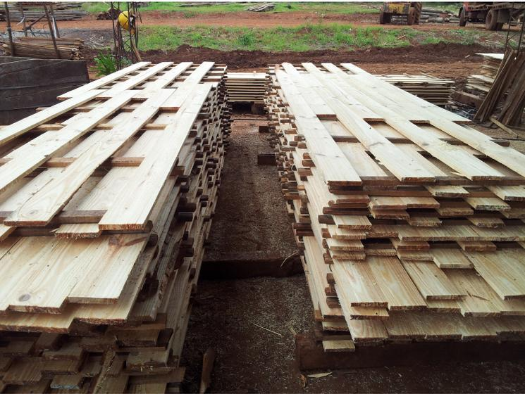
Además, entre las capas de tablas se colocan separadores para que no estén en contacto directo unas con otras y facilite el paso del aire entre ellas. Cuando las tablas son muy largas, se acomodan una al lado de la otra sin dejar los espacios mostrados en el diagrama.
