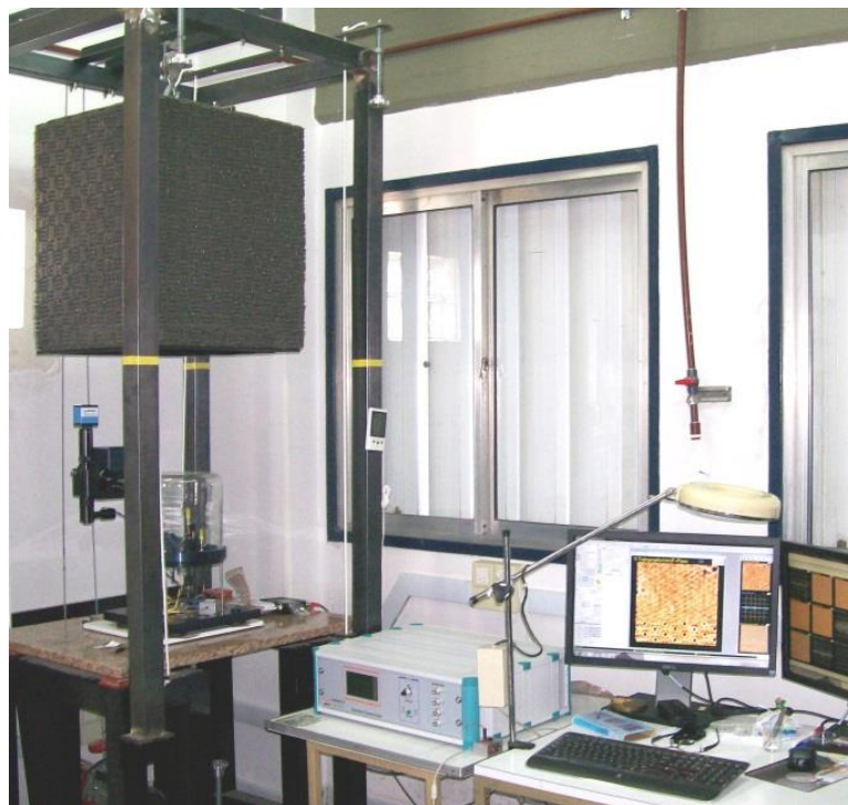
Fig. 3-10) Fotografía del equipo SPM perteneciente al LASUI (IFIS-Litoral), se observa a la izquierda el SPM sobre la mesada de mármol sostenido por el sistema anti-vibratorio. A la derecha se muestra la parte electrónica que maneja el equipo denominado modulo Dulcinea de Nanotec Electronica SL, conectado a los monitores respectivos.
