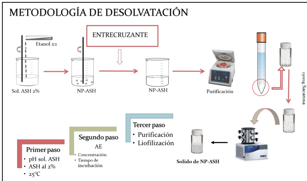
Figura 3.1.1. Esquema de los pasos a seguir para la obtención de NP-ASH.
