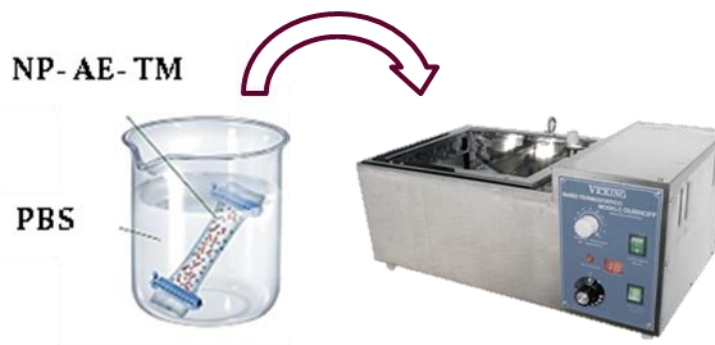
Figura 3.5.1. Sistemas de diálisis utilizado para el ensayo de liberación in vitro de las NP-ASH con TM.
