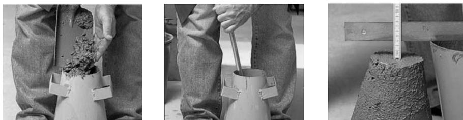
Fig. 7-4. Imágenes ensayo consistencia
