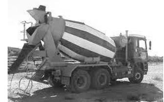
Fig. 7-6. Transporte de Hormigón elaborado en planta
