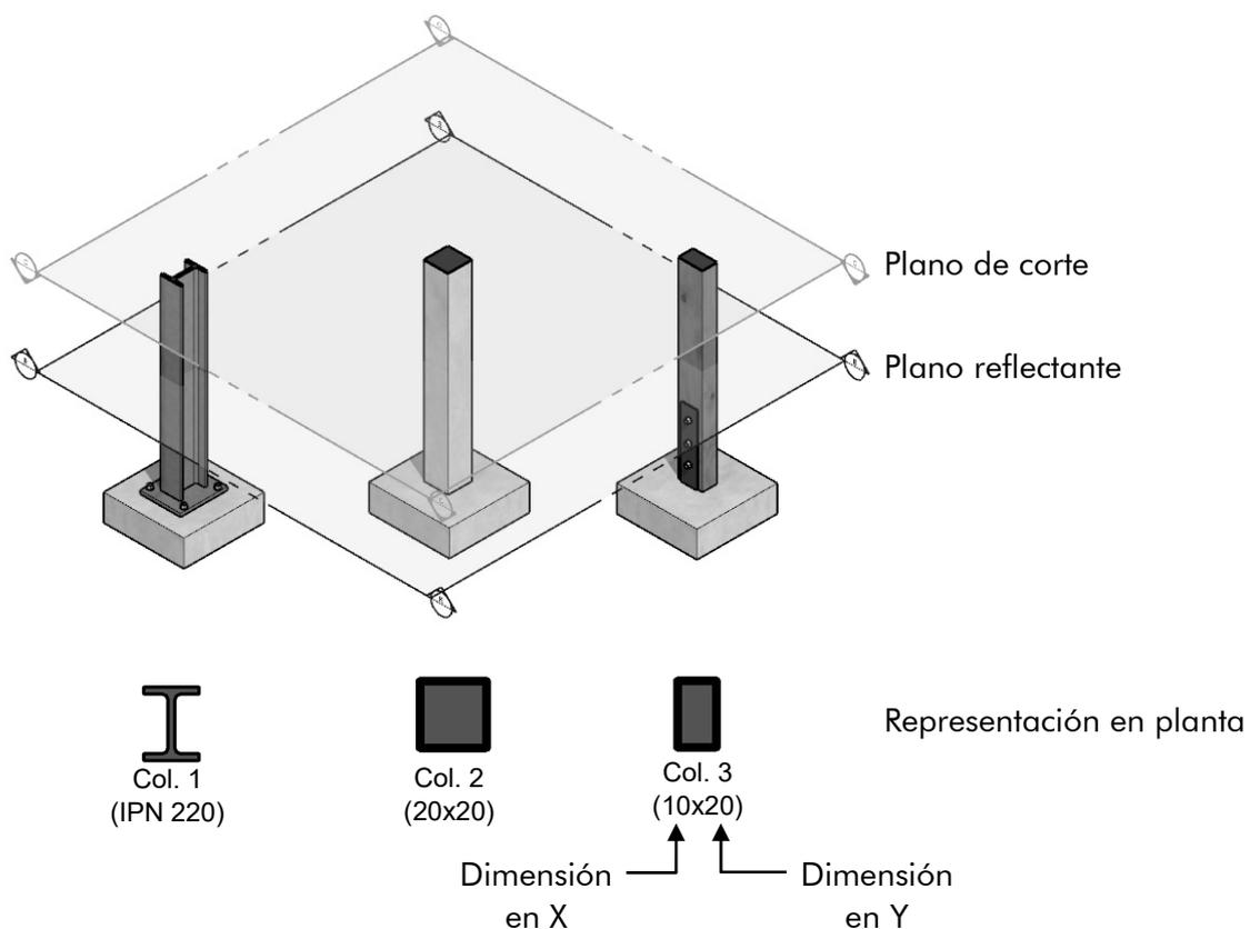
Fig. 19 – Representación en planta de columnas y designaciones
