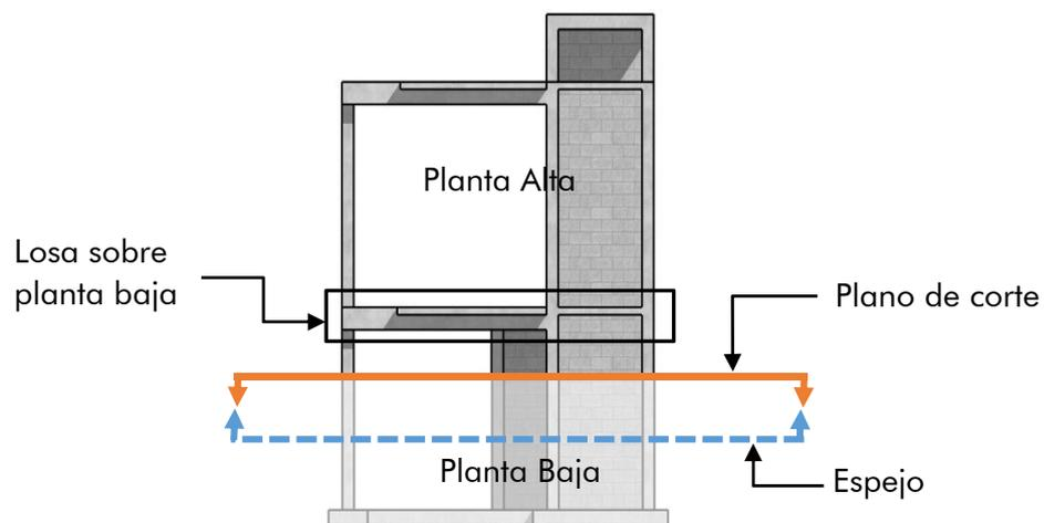
Fig. 8 - Posición del plano de corte
