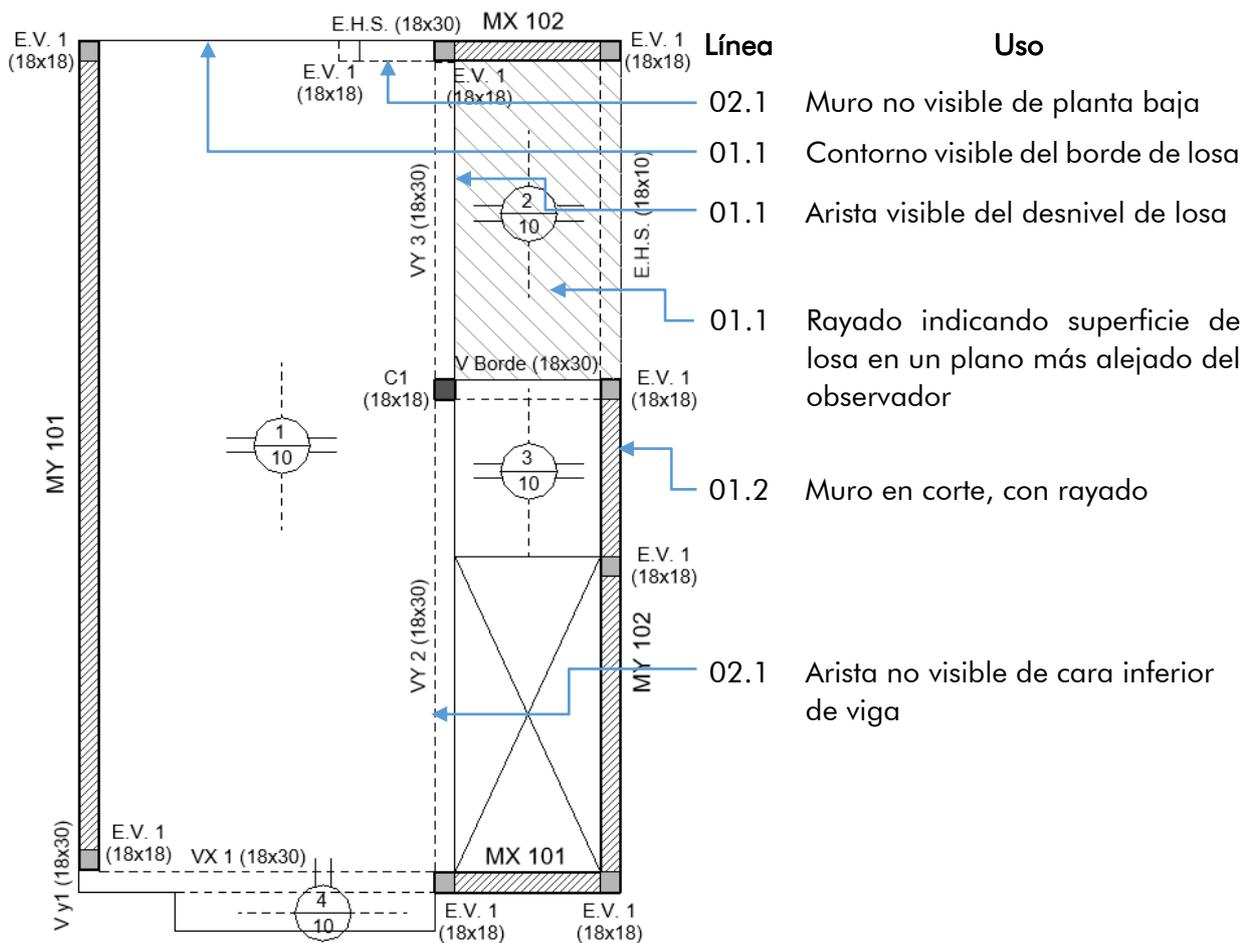
Fig. 7 – Losa sobre planta baja - Método de proyección ortogonal directa
