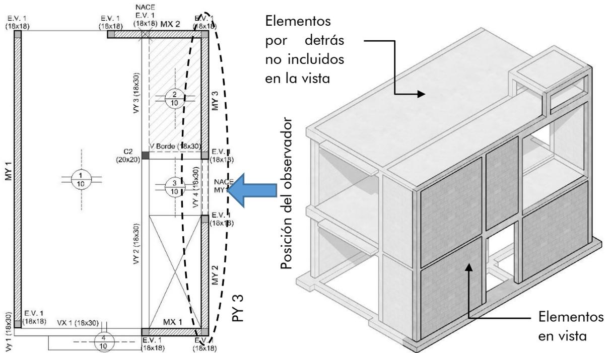
Fig. 15 – Dibujo de planos resistentes verticales
