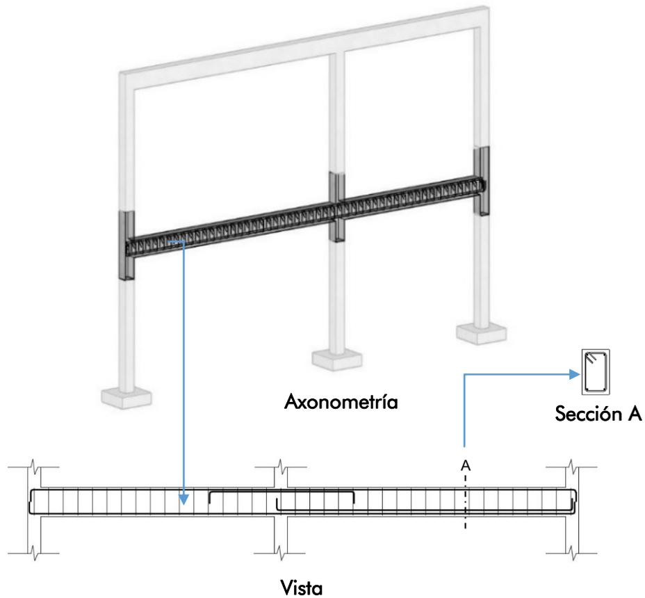
Fig. 25 – Sector a representar en vista para el detallado de armaduras de viga
