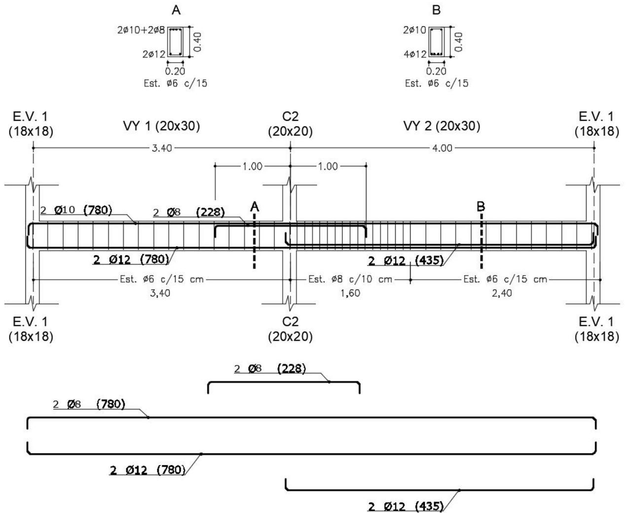
Fig. 29 – Detalle completo de armaduras de viga
