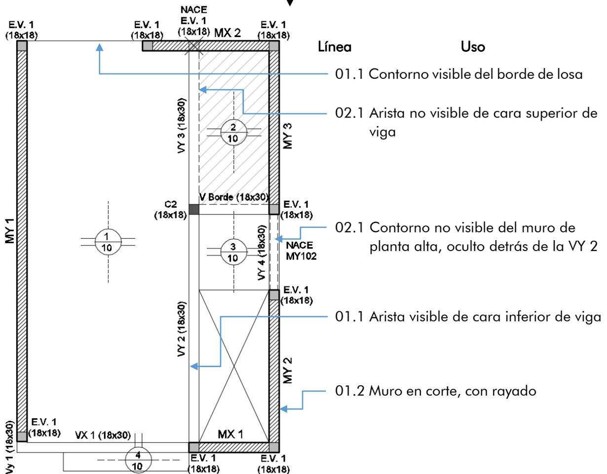
Fig. 9 - Losa sobre planta baja - Método de proyección ortogonal reflejada
