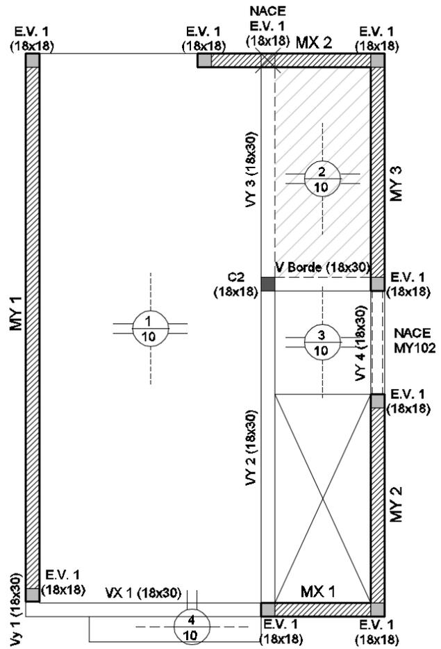
Fig. 11 – Izq.: Planta baja (Arquitectura) - Der.: Losa sobre planta baja (Estructura)
