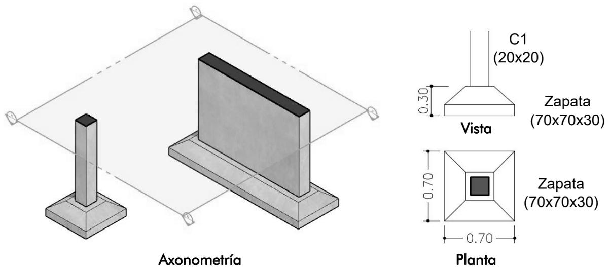
Fig. 43 – Zapatas puntuales y corridas
