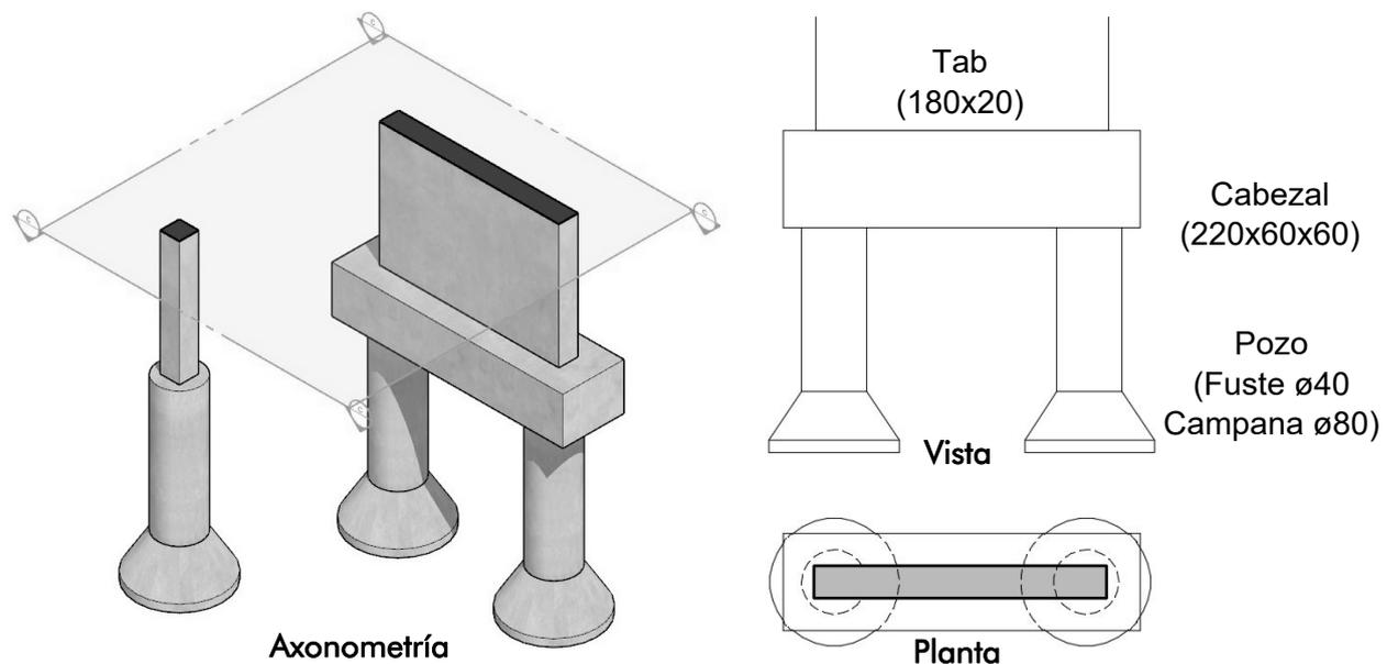
Fig. 44 – Pozos y cabezales
