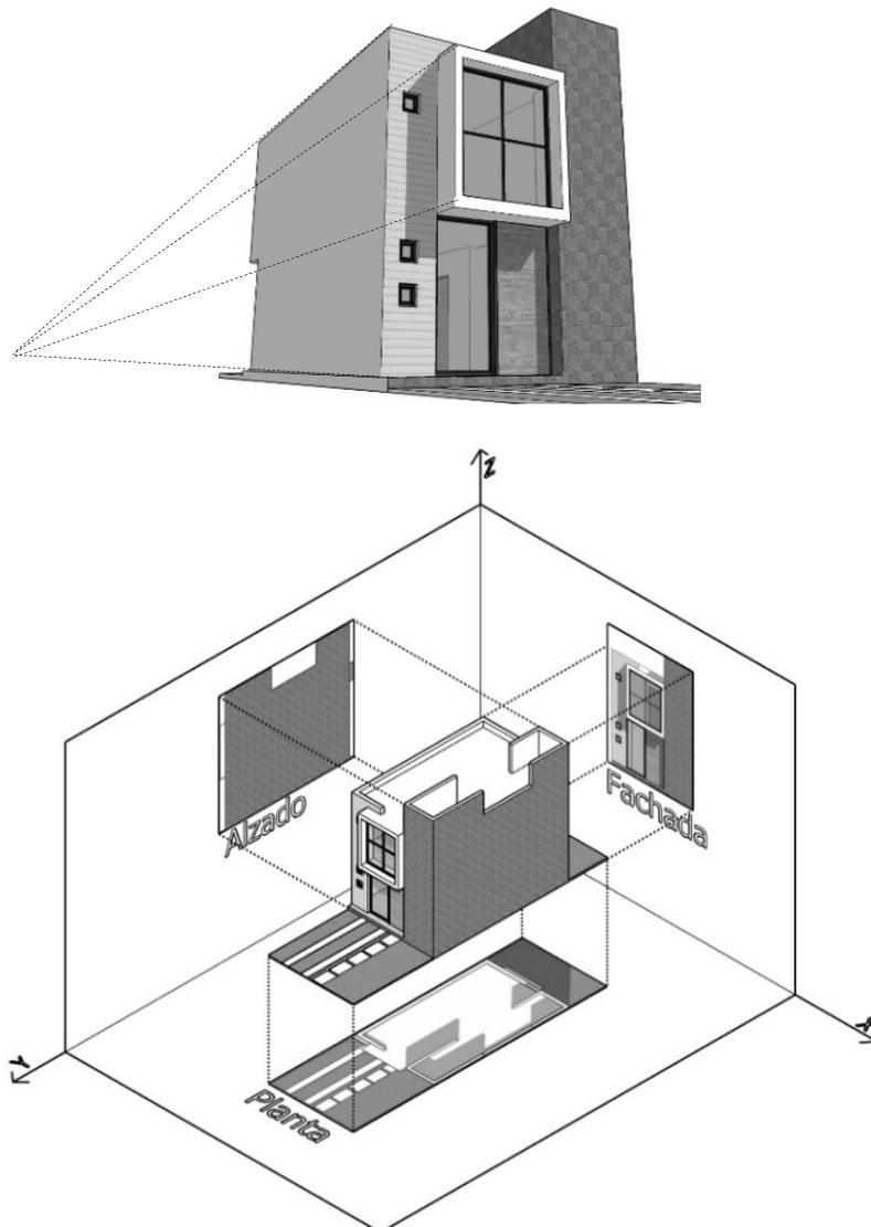
Fig. 1 - Arriba: Proyección cónica – Abajo: Proyección ortogonal
