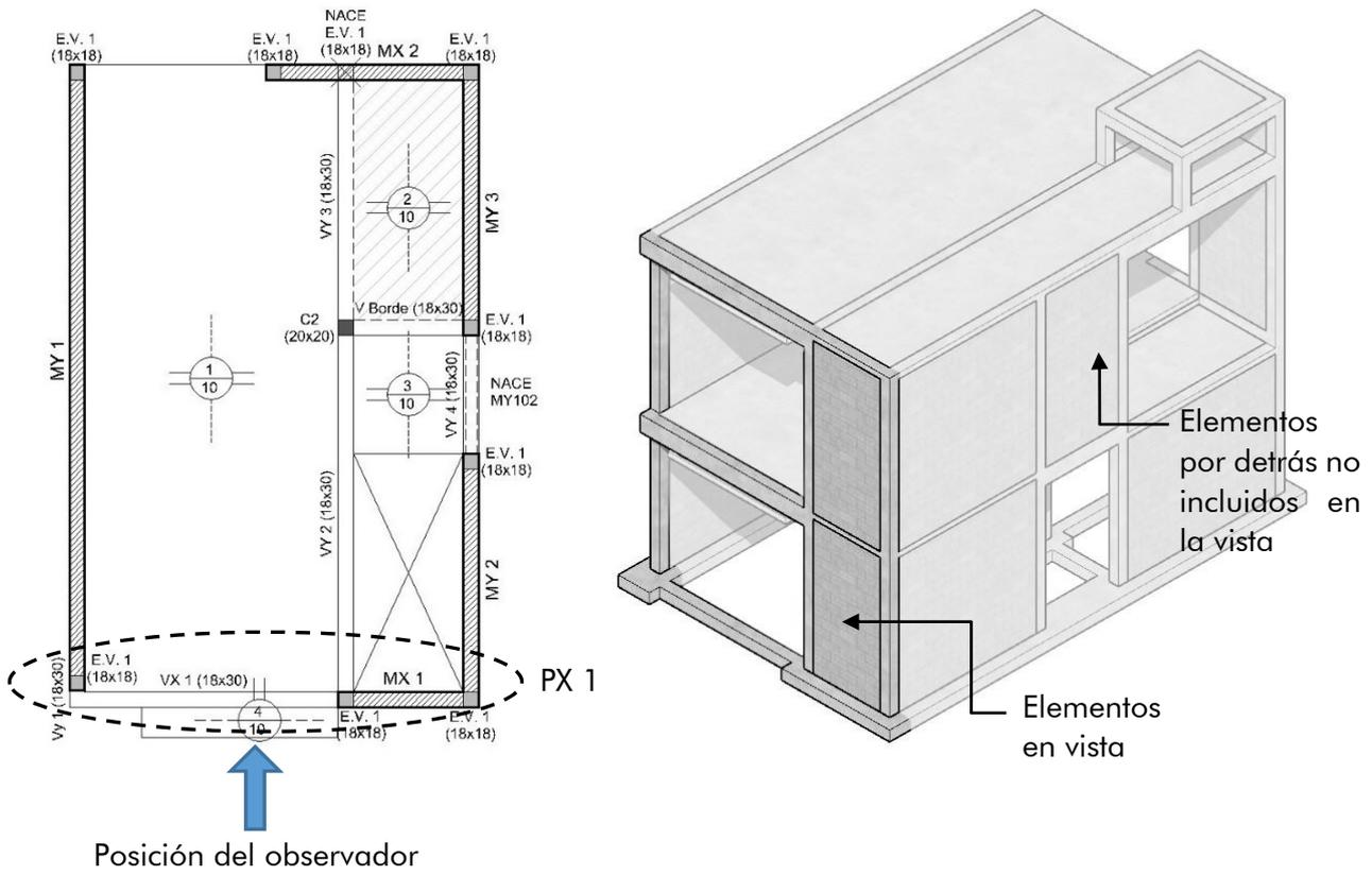
Fig. 13 – Dibujo de planos resistentes verticales
