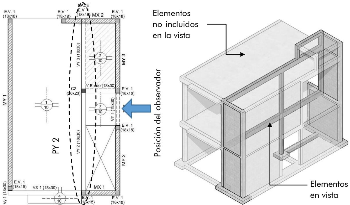
Fig. 17. - Dibujo de planos resistentes verticales
