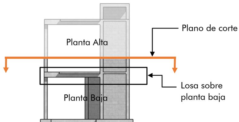
Fig. 6 - Posición del plano de corte
