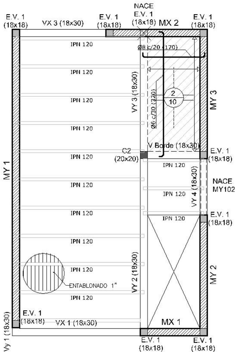
Fig. 42 – Losas sobre planta baja con IPN
