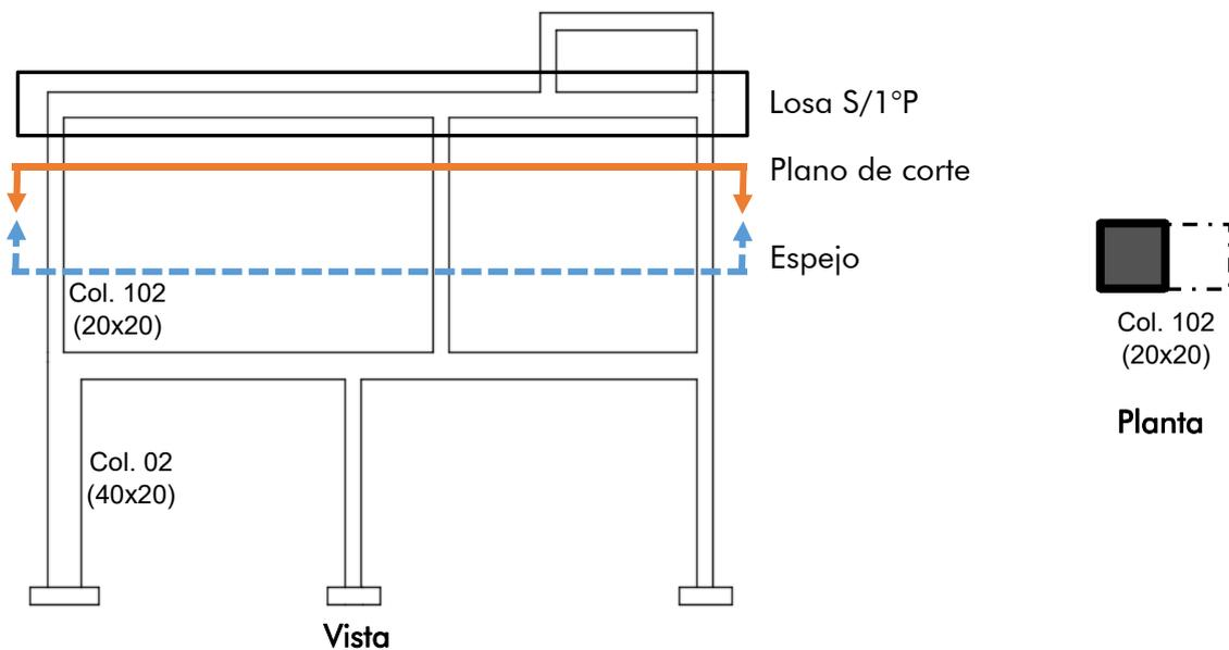
Fig. 21 – Reducción de sección de columna con respecto al nivel inferior
