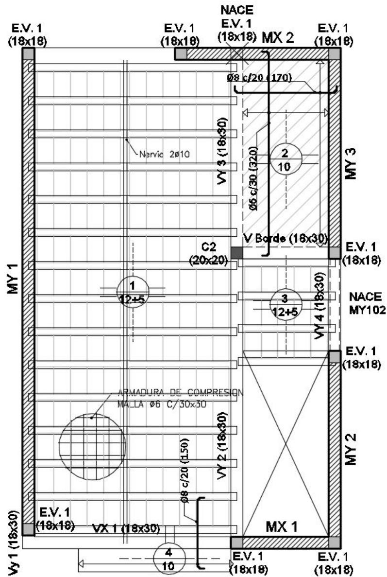
Fig. 40 – Losas sobre planta baja con viguetas
