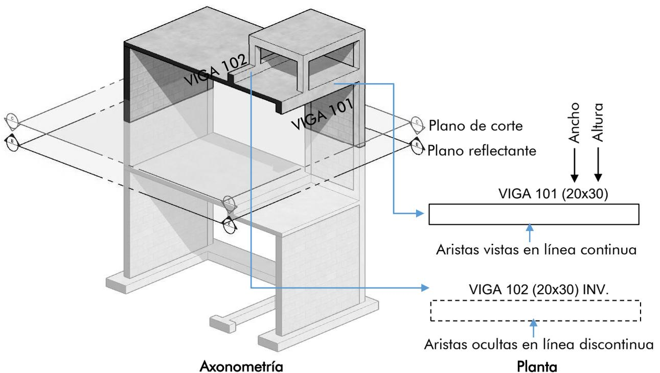
Fig. 24 – Representación en planta de vigas
