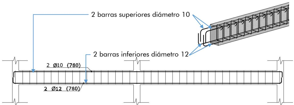
Fig. 26 – Detalle de armaduras de viga
