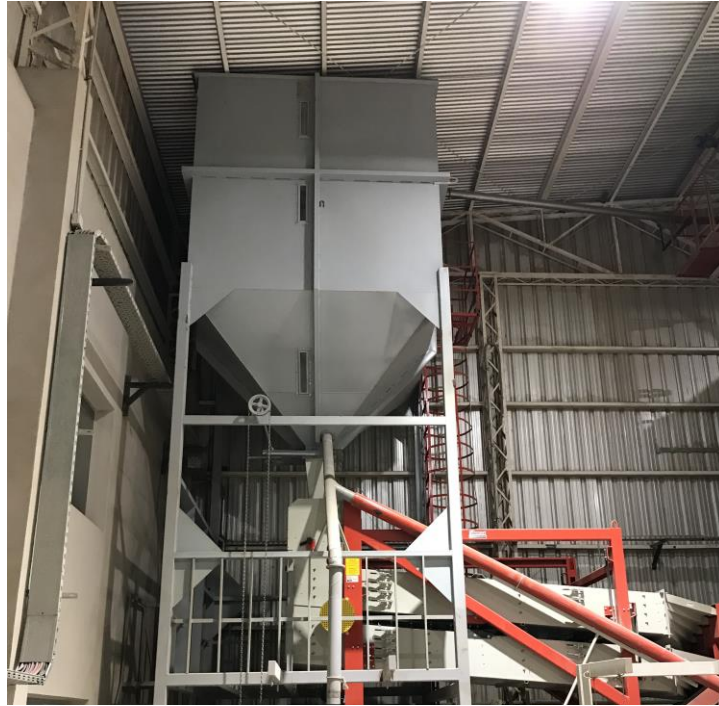
Figura 10: Sistema de calibrado por zarandas de la empresa CAyFE Export S.A
