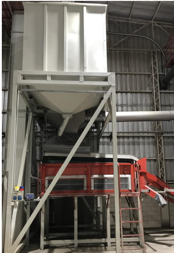
Figura 11: Sistema de mesa densimétrica de la empresa CAYFE Export S.A
