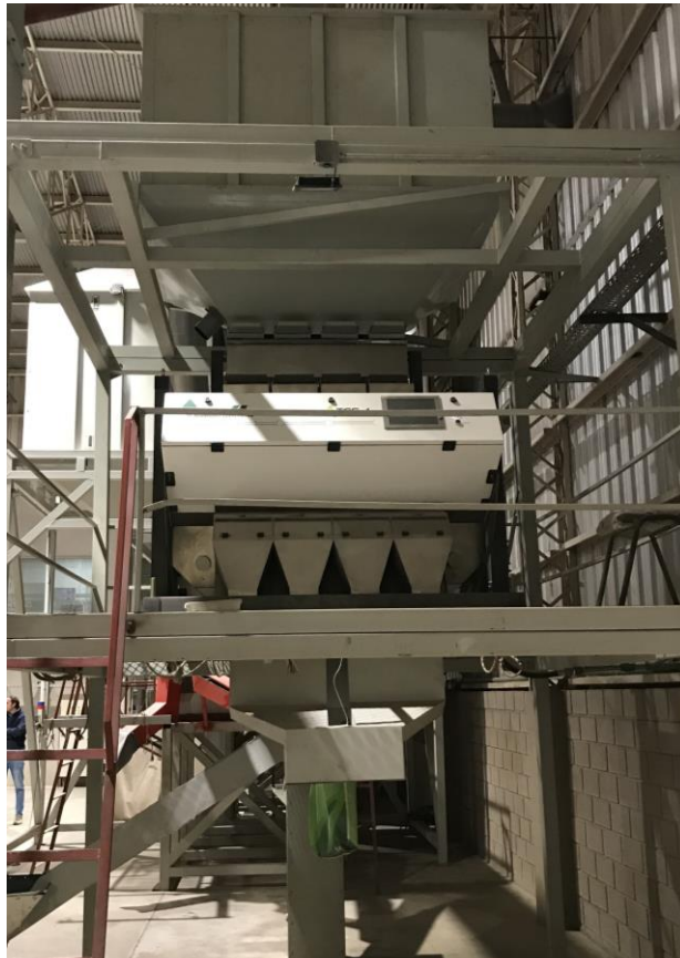
Figura 12: Sistema de selección colorimétrica de la empresa CAYFE Export S.A
